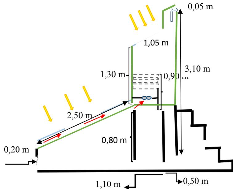
Figura 1: Corte del sistema colector – Cámara de secado
