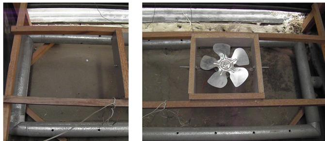
*Foto 2.- Cañería interior de circulación de aire caliente en el gabinete.*
