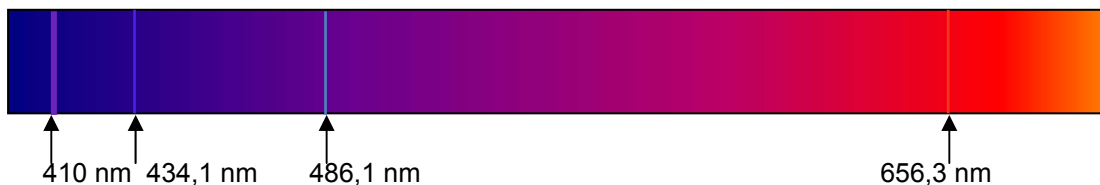
Fig. 1.8: Posición de las líneas correspondientes al espectro del H en la región visible-UVA
