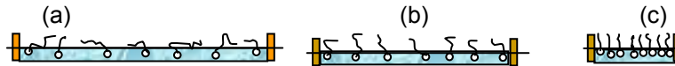
Figura 10.26: Cambios asociados a la compresión de un film de un surfactante. Se observa que, a medida el área accesible se reduce, las moléculas se empaquetan haciéndose más difícil la compresión. Esto se observa en la Figura 10.25 (a). En algunos sistemas se pueden observar el equivalente a cambios de fase entre distintas estructuras de los surfactantes.
