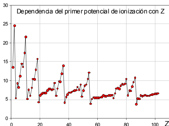
Figura 4.12: Comportamiento del primer potencial de ionización de elementos como función del número atómico. Se observa cierta regularidad que está estrechamente relacionada con el llenado de los distintos estados electrónicos y niveles de energía.
