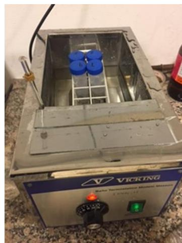
Fig. 80. Muestras en saliva artificial y estufa para muestras a 37°C
