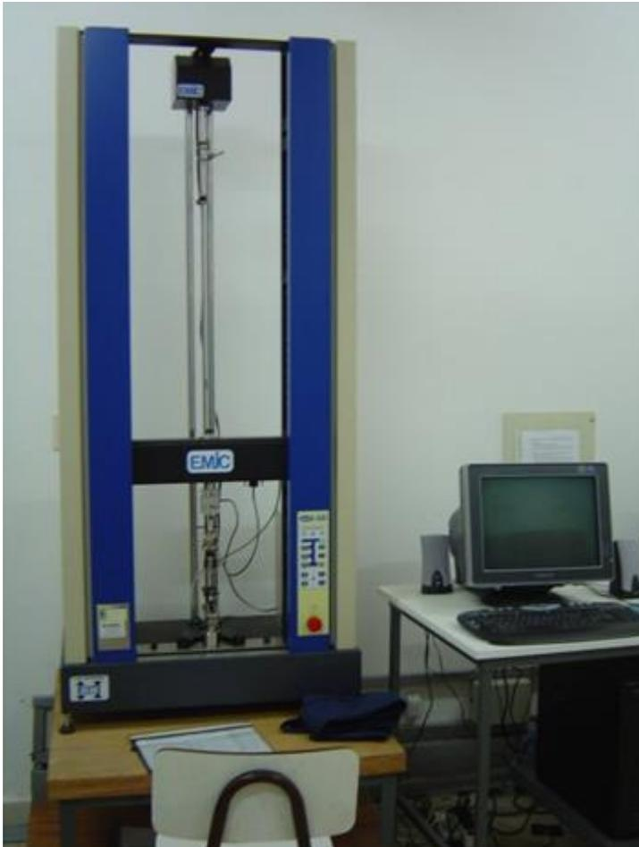
Fig. 72. Máquina universal de ensayos mecánicos
