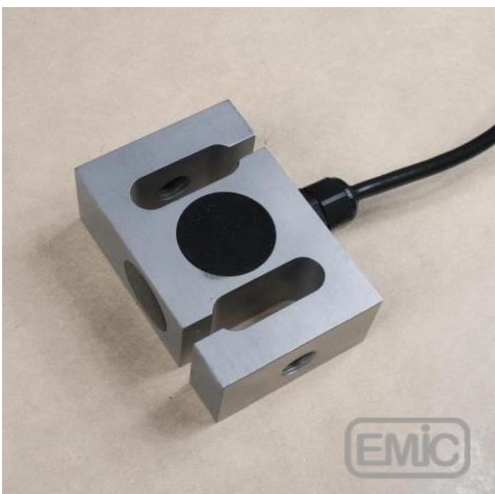
Fig. 73. Celda de carga
