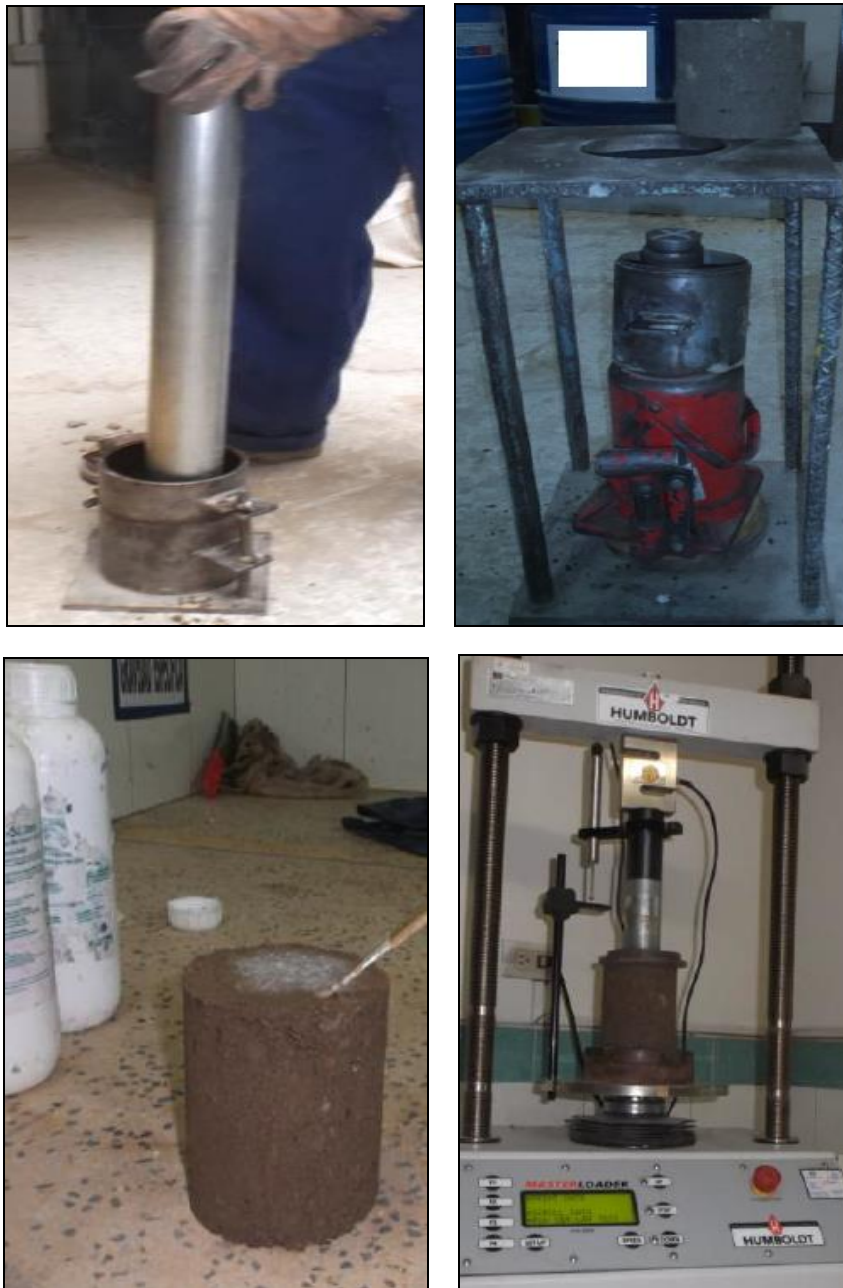
Fig. 5. Fases del proceso de preparación de las muestras compresión simple. Fuente: Registro fotográfico propio, año 2016. [11]
