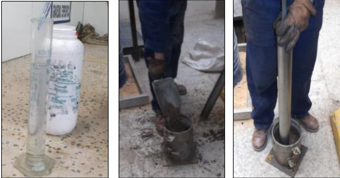
Fig. 4. Fases del proceso de preparación de las muestras CBR. Fuente: Registro fotográfico propio, año 2016. [9]
