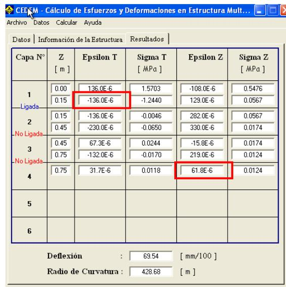
Fig. 8. Resultados estructura Tercer Carril No. 2, 3 y 4.
