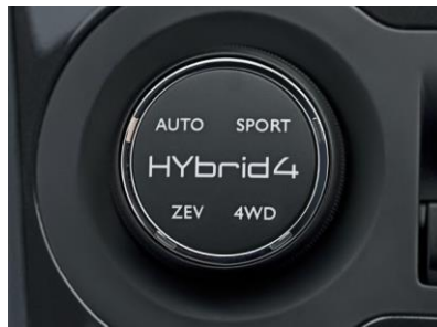
Figura 25: Modalità di guida di un sistema Hybrid 4.
