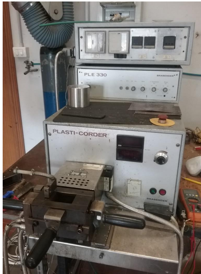
Figura 129: Foto del miscelatore Plasti-Corder Brabender utilizzato.
