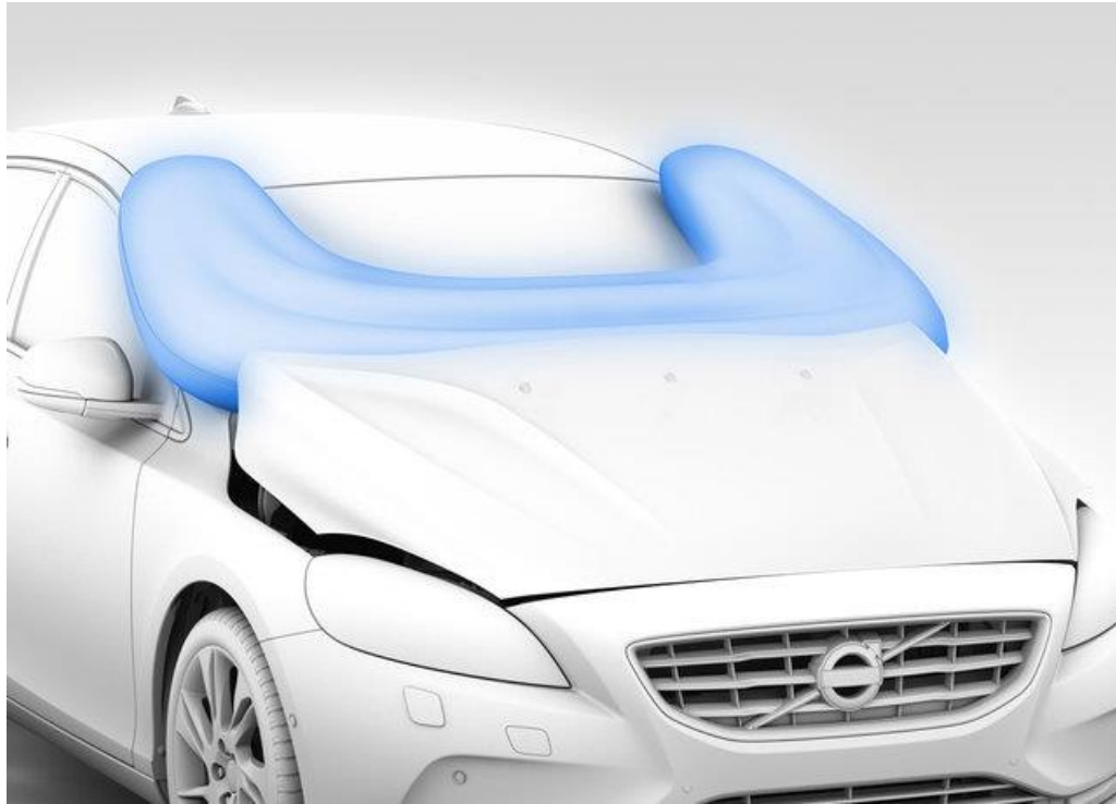
Figura 75: esempio di dispositivi di sicurezza passiva quali gli airbags per la testa posti sul bordo inferiore del parabrezza.
