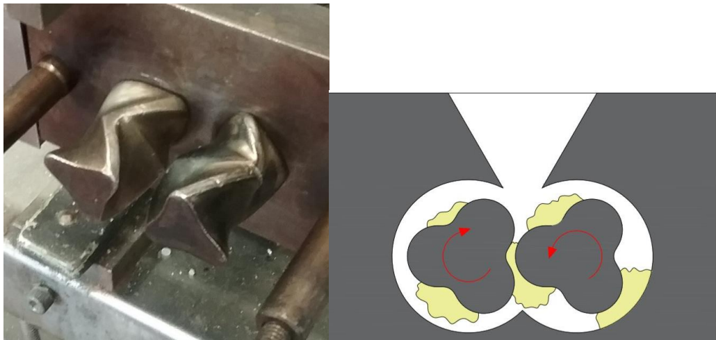
Figura 130: A sinistra: foto delle camme del miscelatore. A destra: schema delle camme in funzione.
