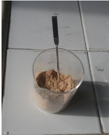
Figura 128: Mescola di PLA e farina di faggio prima della miscelazione.
