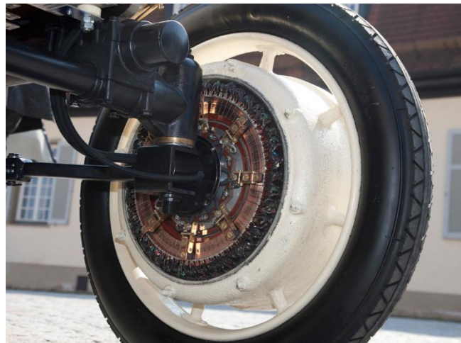
Figura 17: Dettaglio motore elettrico.
