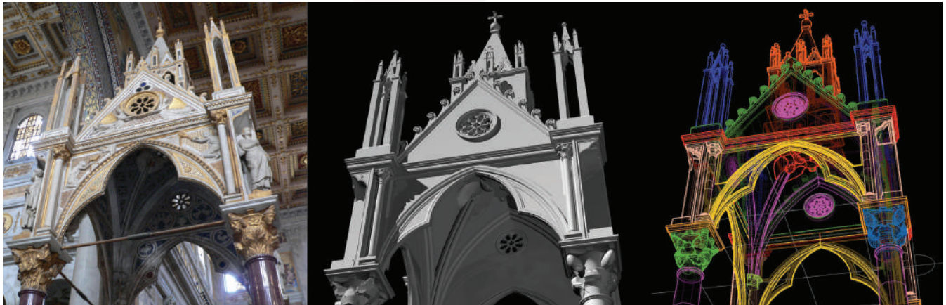
Fig. 2 Roma, San Paolo fuori le Mura, ciborio. Tre aspetti del rilievo architettonico: il rilevamento cromatico mediante fotografia digitale, il rilevamento morfologico tramite rendering del modello geometrico, la scomposizione del soggetto in elementi assemblati.
