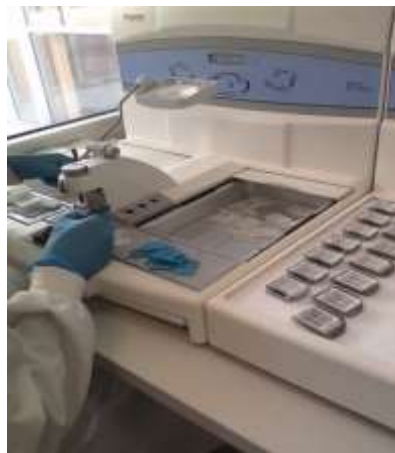
Figura 3- Bancada de inclusão em parafina de amostras para histologia (Microm EC-350-1Thermo Scientific™).
