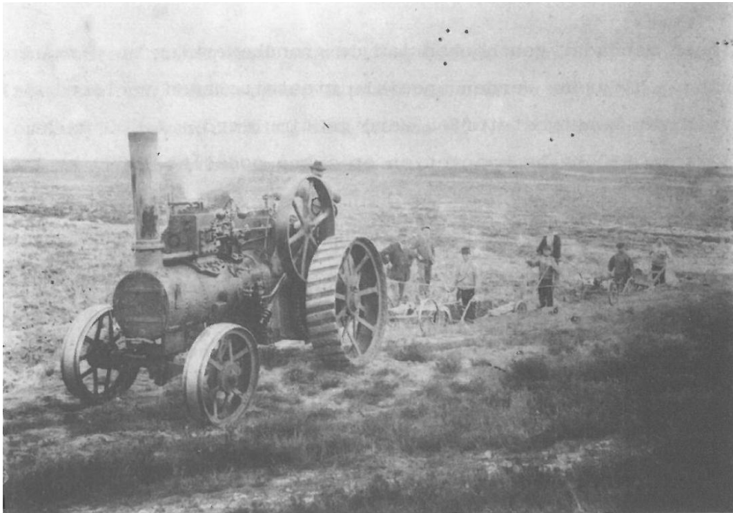
Figuur 10. De werking van een bosploeg bestaande uit een stoomlocomotief met vier ploegen (uit Dufrane 1985: 27, gedateerd in 1900).
