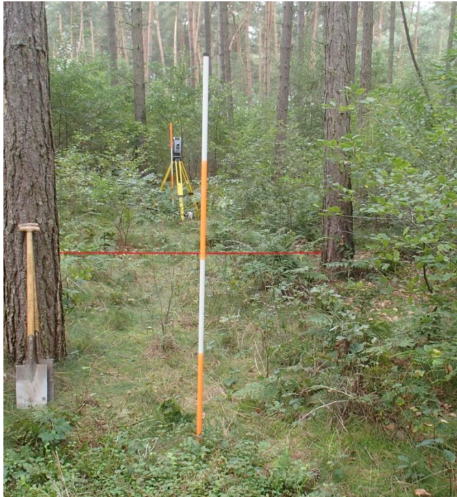
Figuur 3. Lokalisatie van de wal met behulp van het totaalstation. De rode lijn toont waar de wal zich zou bevinden.
