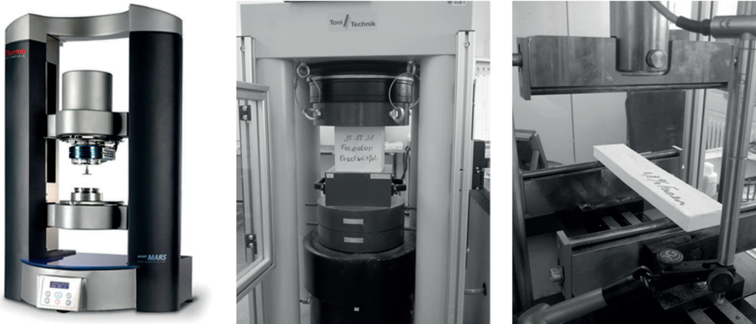
Abb. 5.1: Bestimmung der Fließeigenschaften von Frischbetonen im Rheometer HAAKE MARS III (li.), Ermittlung der Druckfestigkeit (mi.), Ermittlung der 3-Punkt-Biegezugfestigkeit (re.)
