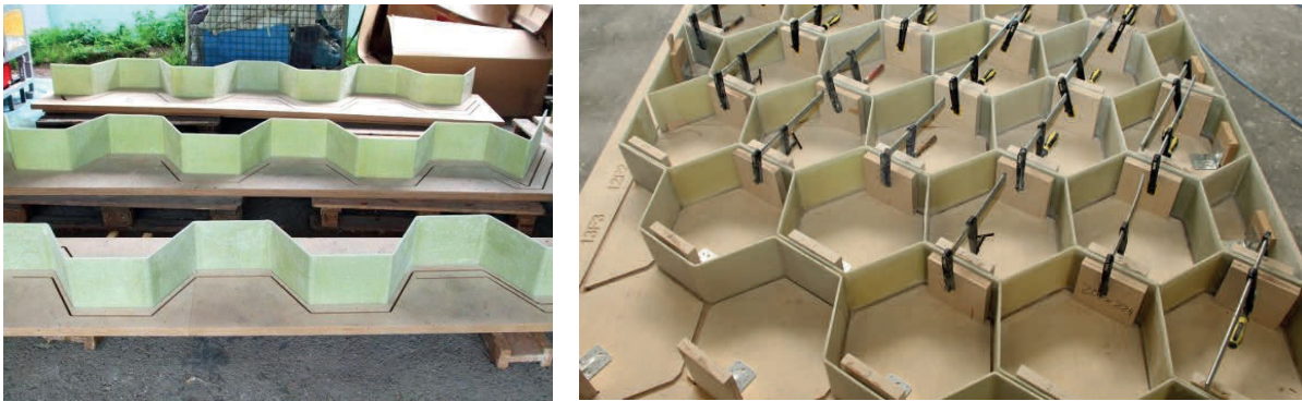
Abb. 4.21: Fertigung des Kernes in mäanderförmigen Halbwaben (li.), Verklebung der Halbwaben (re.)
