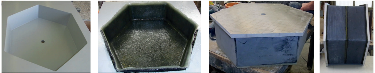
Abb. 4.23: Fertigung des Wickelkerns (Modellbau, Abformung, Wabenwickelwerkzeug, Endmontage)
