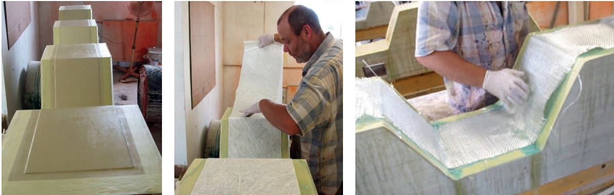
Abb. 4.20: Formwerkzeug (li.), Laminieren im Formwerkzeug (mi., re.)
