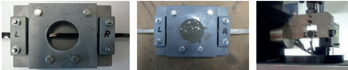
Abb. 5.12: Einbettung der g-Rovings in die Spannform (li., mi.); Faserauszugsversuch (re.)
