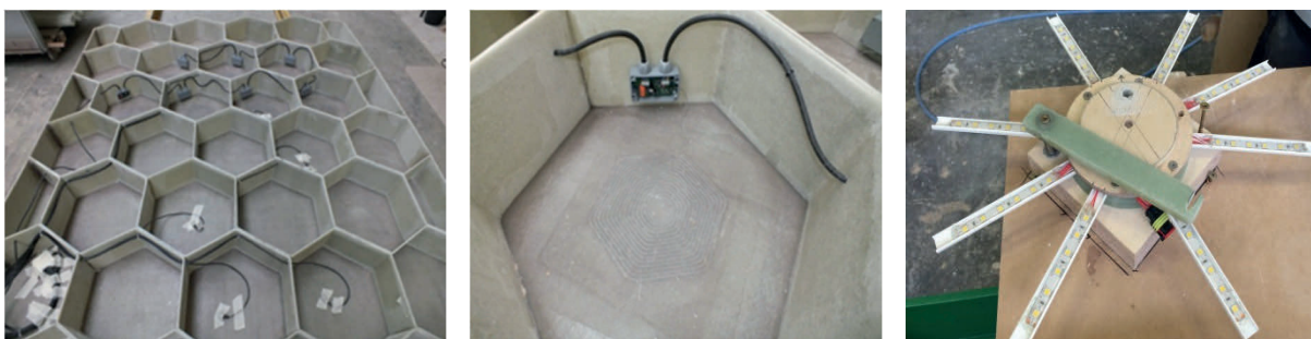
Abb. 4.44: Brückenelement mit kaskadierten Antennen (li.), Wabensegment mit integriertem Sensor und Verarbeitungselektronik (mi.), LED-Beleuchtungsschirm (re.)
