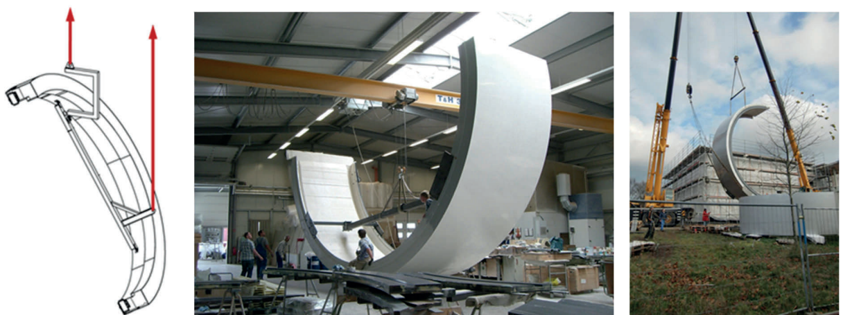
Abb. 4.14: Manipulationsvorrichtung (li.), Entformung des Mittelmoduls (mi.), Montage des Mittelmoduls (re.)
