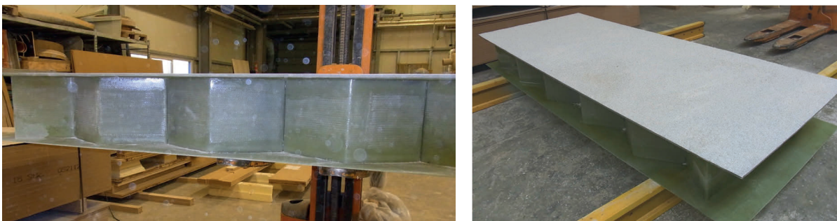
Abb. 4.22: GFK-Wabensandwich mit Deckschichten
