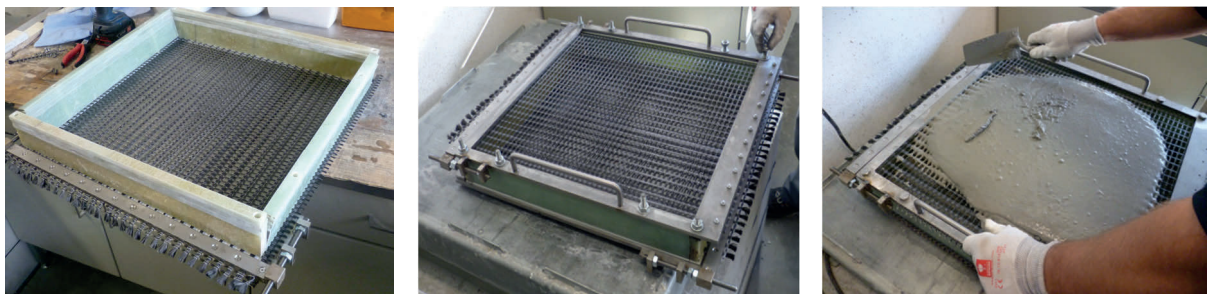
Abb. 5.16: Prozesskette zur Herstellung von textilbewehrten Tragplatten im Laborformat (500 mm x 500 mm)
