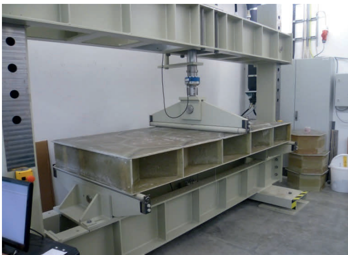
Abb. 4.27: Biegeversuch am großformatigen Probekörper
