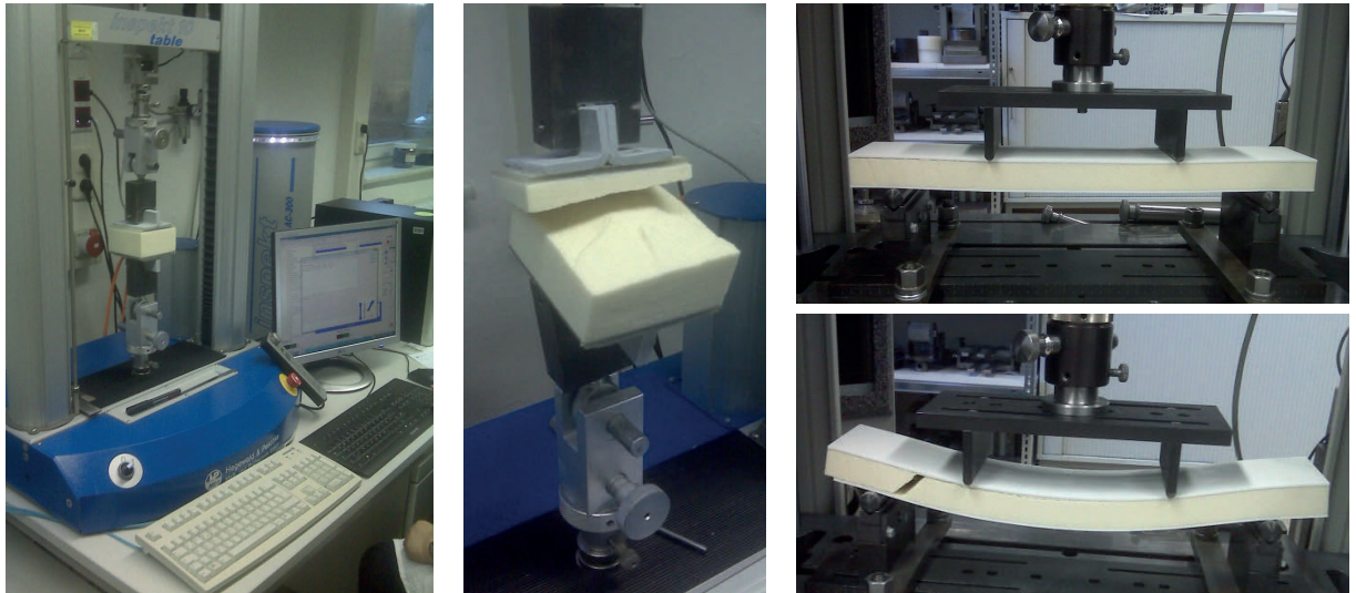
Abb. 4.4: Exemplarische Versuchskonfigurationen; Zugversuch (li., mi.), 4-Punkt-Biegeversuch (re.)
