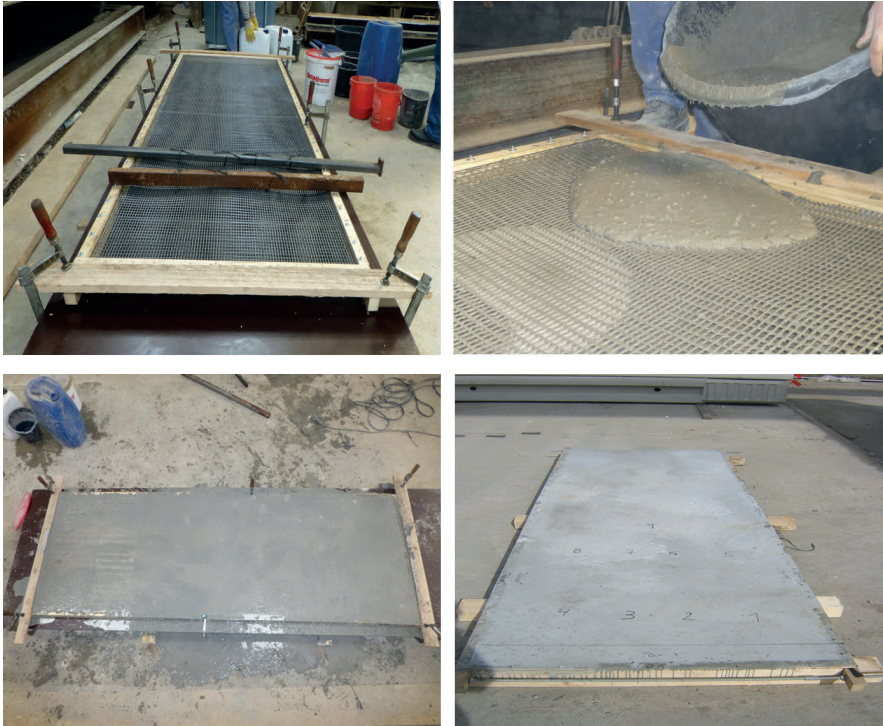
Abb. 5.18: Herstellung der textilbewehrten Referenzplatten im Betonwerk
