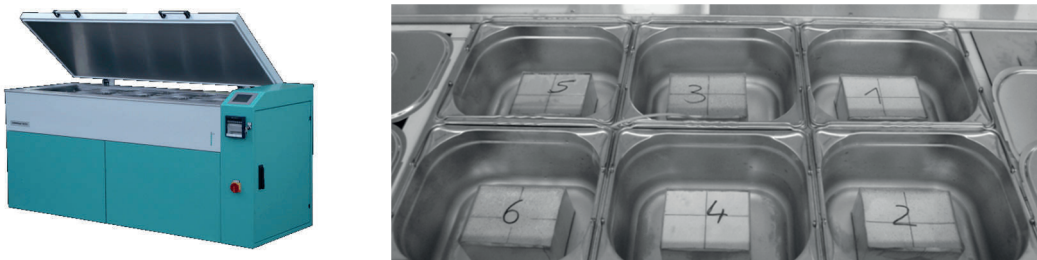
Abb. 5.2: CDF und CIF-Test zur Bestimmung der Frost- u. Frost-Tau-Wechselbeständigkeit in der Klimakammer
