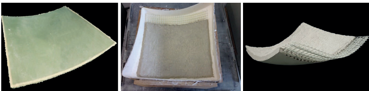
Abb. 5.25: Fertigungsversuche zum Systemaufbau von GFK-Schalungen für Beton-Leichtbauschalen
