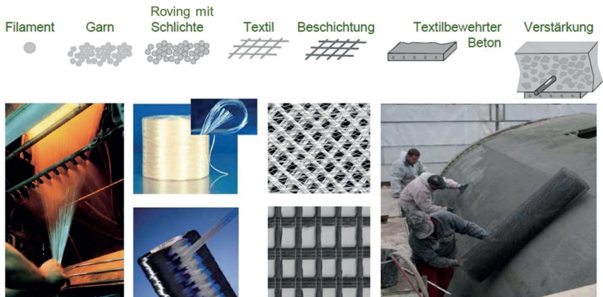
Abb. 3.15: Textilbeton „Vom Filament zum Bauteil“ [Stfi]
