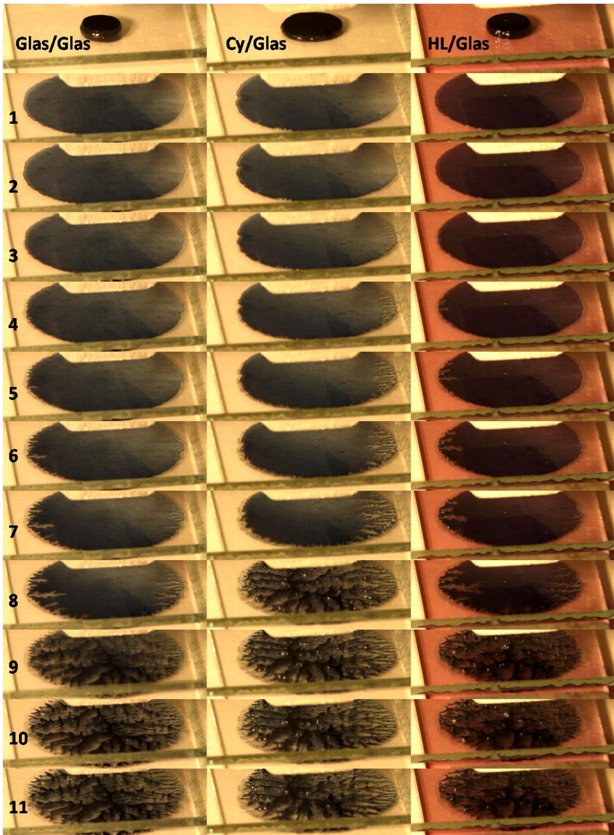
Abbildung 6-42: Tackexperiment mit Clevios SV3HV zwischen Glasplatten (links), Cytop™ und Glas (Mitte) und Glas und Halbleiter (rechts). Trenngeschwindigkeit: 72 mm/Min; 25 Bilder/s, abgebildet jedes zweite Bild ab Trennstart, Clevios SV3HV-Menge 44 \pm 4 mg, Schichtdicke am Wendepunkt ca. 90 \mu\text{m} .
