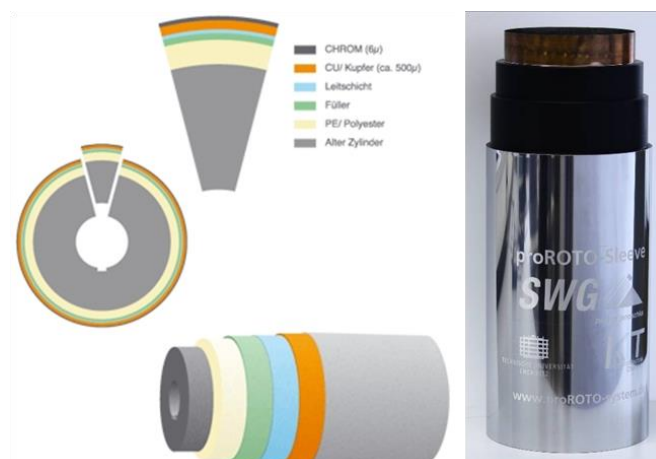
Abbildung 2-5: Aufbau eines Zylinders der Fa. BECK Swissform mit Kunststoff-Anwendung; [35] (links) und ein Kunststoff-Komposit-Sleeve-Zylinder, eine Zusammenarbeit der Firma SWG und TU Chemnitz (rechts).
