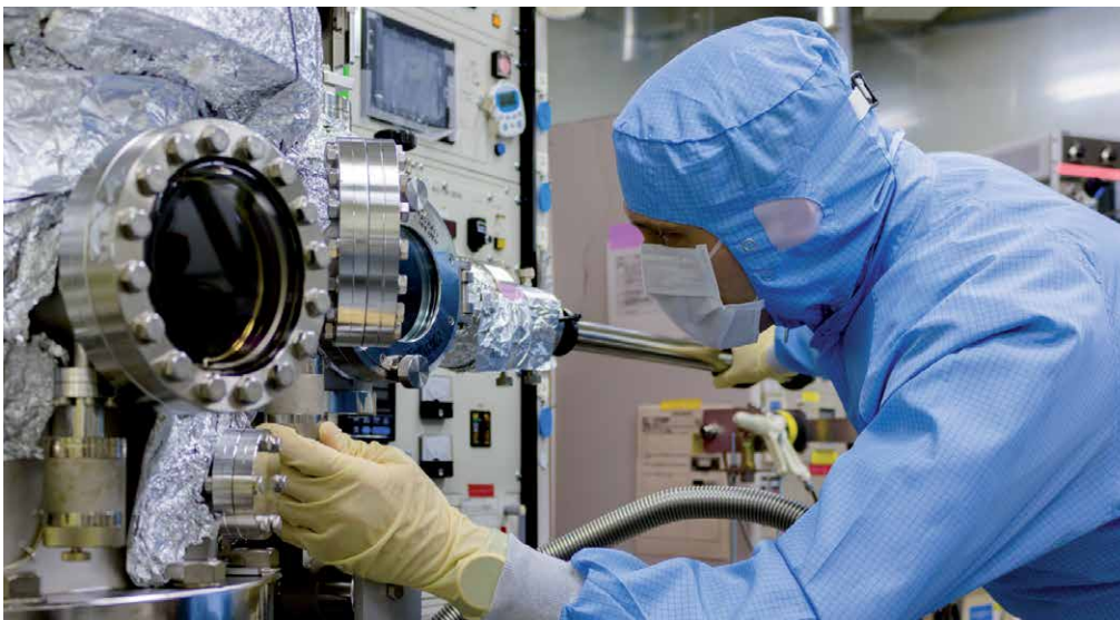
Dr. Jörg Frömel belädt eine Magnetron-Sputteranlage mit einer Probe. Foto: Florian Kurth
