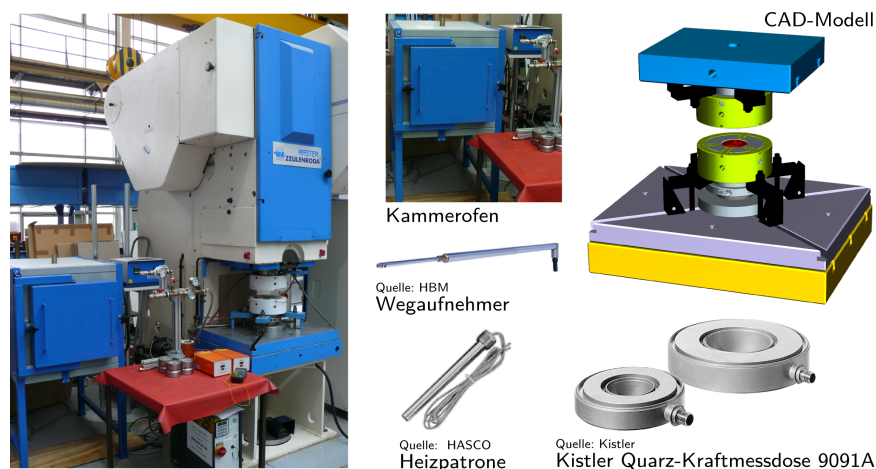
Abb. 3.3: Darstellung des Experimentierstands mit allen wesentlichen Komponenten
