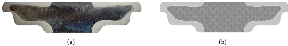
Abb. 5.15: Vergleich Experiment mit Simulation, Querschnitt, T_{\text{Umform}} = 300\text{ °C} , T_{\text{Gesenk}} = 200\text{ °C} , G_{A,1} = 4\text{ mm} , \varphi_{v,a} = 1,55 , (a) Experiment, (b) Simulation
