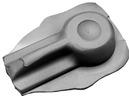
Abb. 4.22: Schmiedeprozess SMART-Body T_{\text{Umform}} = 300 \text{ }^\circ\text{C} , T_{\text{Gesenk}} = 200 \text{ }^\circ\text{C} , G_{S,1} = 0,6 \text{ mm} , \varphi_{v,a} = 0,60
