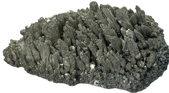
Abb. 2.9: Magnesiumkristalle nach der thermischen Oxidation [94]
