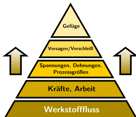
Abb. 2.15: Darstellung der hierarchischen Auswertungsstruktur eines umformtechnischen Problems, [79]
