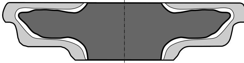
Abb. 6.36: Schematische Darstellung der schädigungsfreien Umformbarkeit, Stauchen
