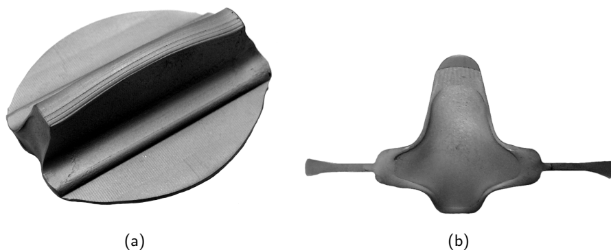
Abb. 4.18: Schmiedeprozess Steigen, T_{\text{Umform}} = 300^\circ\text{C} , T_{\text{Gesenk}} = 200^\circ\text{C} , G_{\text{St},1} = 1\text{ mm} , \varphi_{v,a} = 0,68 , (a) Isometrische Ansicht, (b) Stirnseite ohne erkennbare Schädigung
