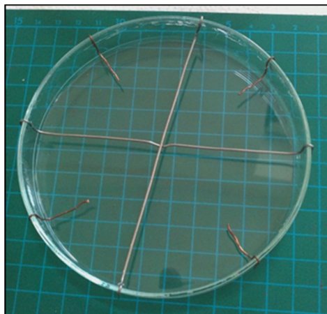
Abb. 48: Fotografische Aufnahme der Petrischale mit einer Drahtbügelkonstruktion zur Membranherstellung.
