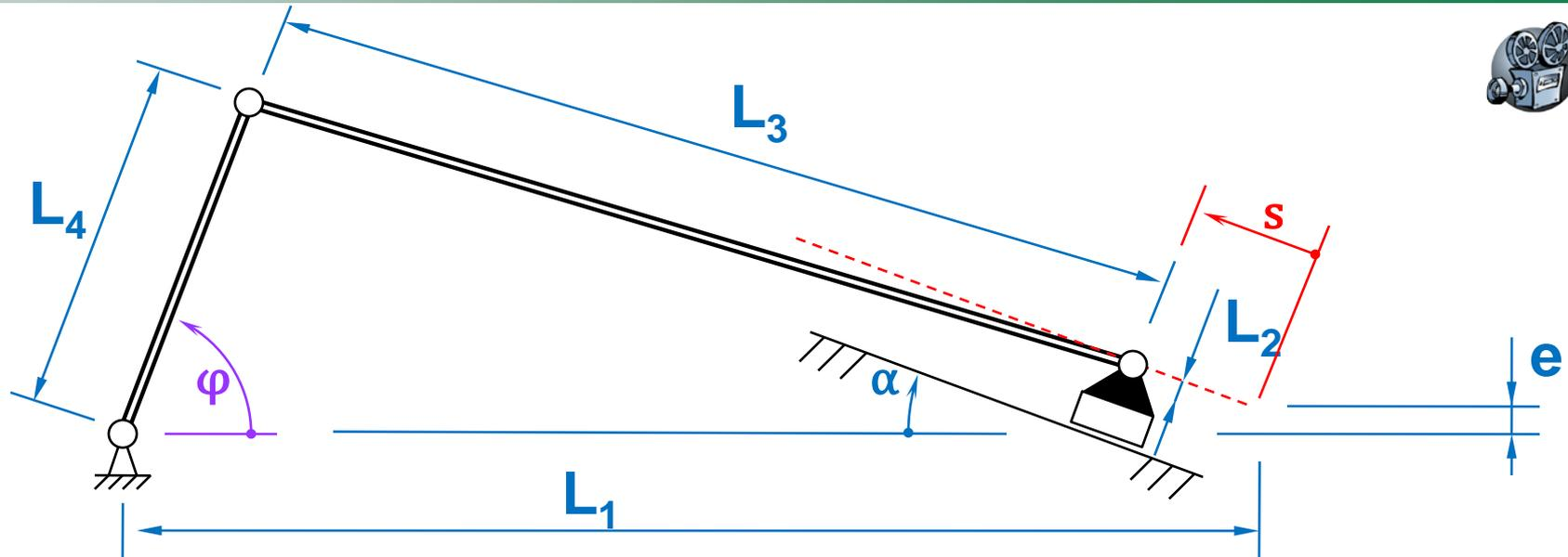
elektronische Kurvenscheibe:  $s(\varphi) = \dots$  (Übertragungsfunktion)
