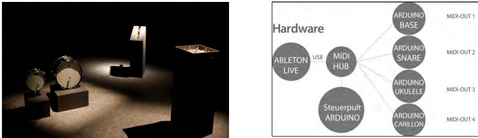
Abbildung 1: Aufbau der Roboter-Instrumente (links), Funktionsdiagramm (rechts)
