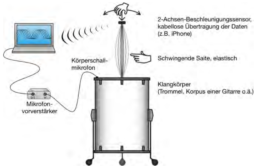
Abbildung 1: Aufbau Hardware Filumis
