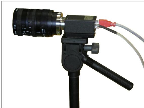
**Abbildung 8: Digitalkamera vom Typ Basler A602fc-2**
