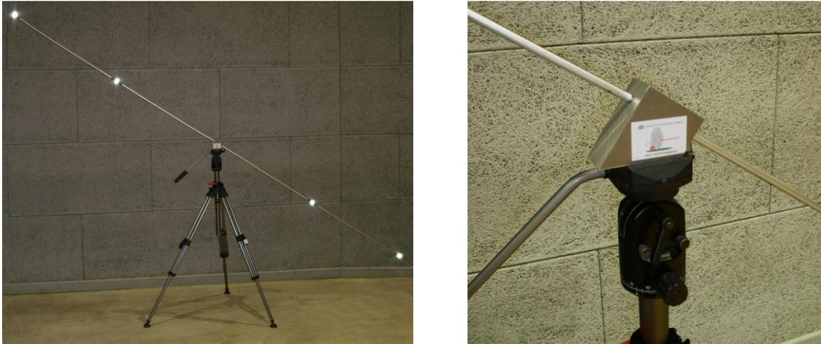
**Abbildung 9: Kalibrationsstab (links), Befestigung auf dem Stativ (rechts)**
