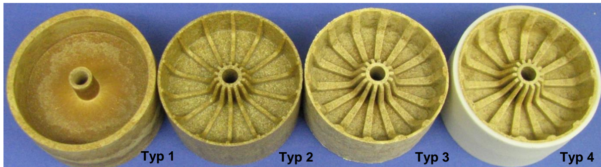
Abb. 5: WPC-Radtypen 1 bis 4 aus verschiedenen WPC-Rezepturen
