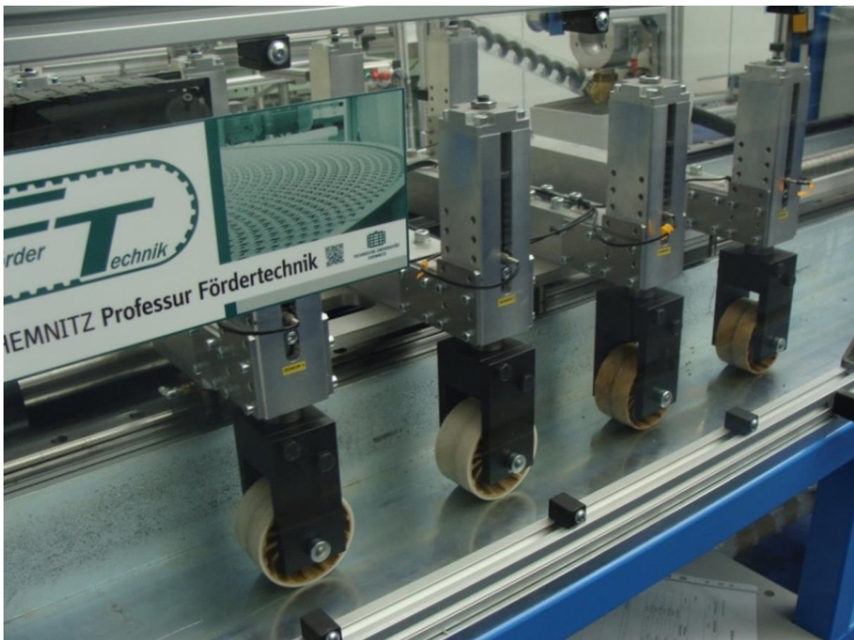
Abb. 13: Dauerlauftest von WPC-Rädern auf dem Rollenprüfstand nach Putzke [9]
