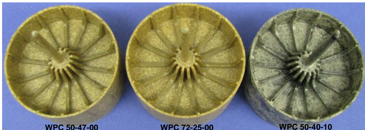
Abb. 6: WPC-Radtyp 2 der 2-ten Bemusterung aus verschiedenen WPC-Rezepturen
