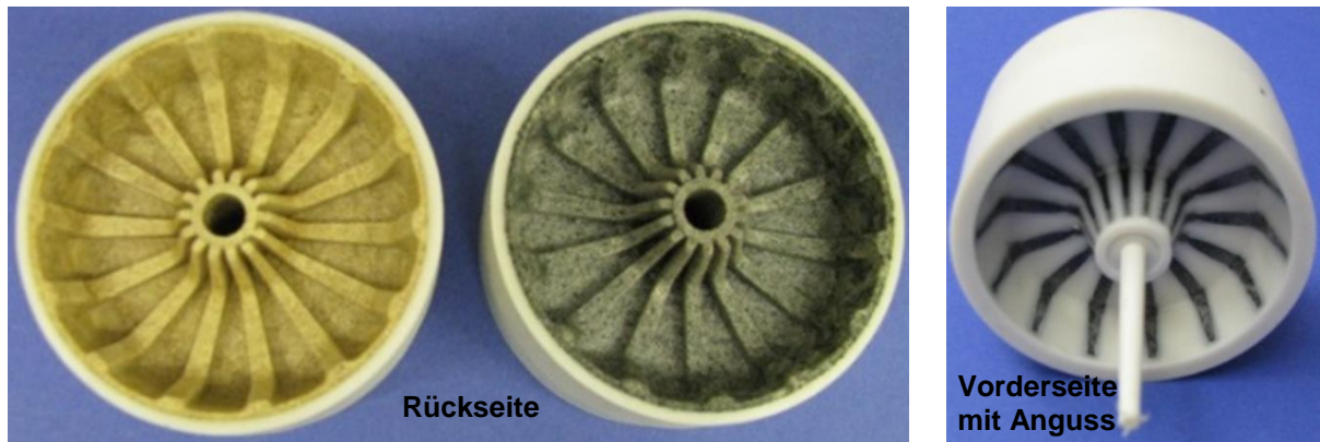
Abb. 7: WPC-Radtyp 4 der 3-ten Bemusterung mit TPE-Bandage aus verschiedenen WPC-Rezepturen – Darstellung von Vorderseite und Rückseite
