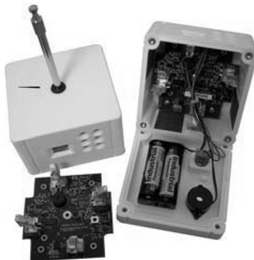
Abbildung 3.38: eXtreme Scale Mote (XSM) mit ATmega 128L Mikrocontroller, 4 MBit Flash Speicher und 433 MHz Chipcon CC1000 Transceiver in einem wasserdichten Gehäuse. Als Sensorik sind Infrarot-Abstandssensoren sowie magnetische und akustische Sensoren vorhanden.
