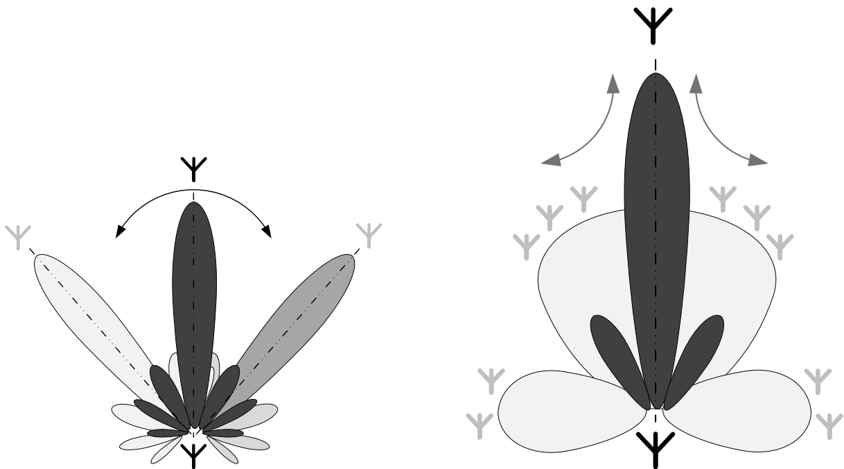
(a) Switched-Beam Antennensystem - Durch den Einsatz von Motorik oder mehrerer Antennensektoren kann der Abstrahlwinkel des Systems gezielt auf einen Bereich gerichtet werden.
