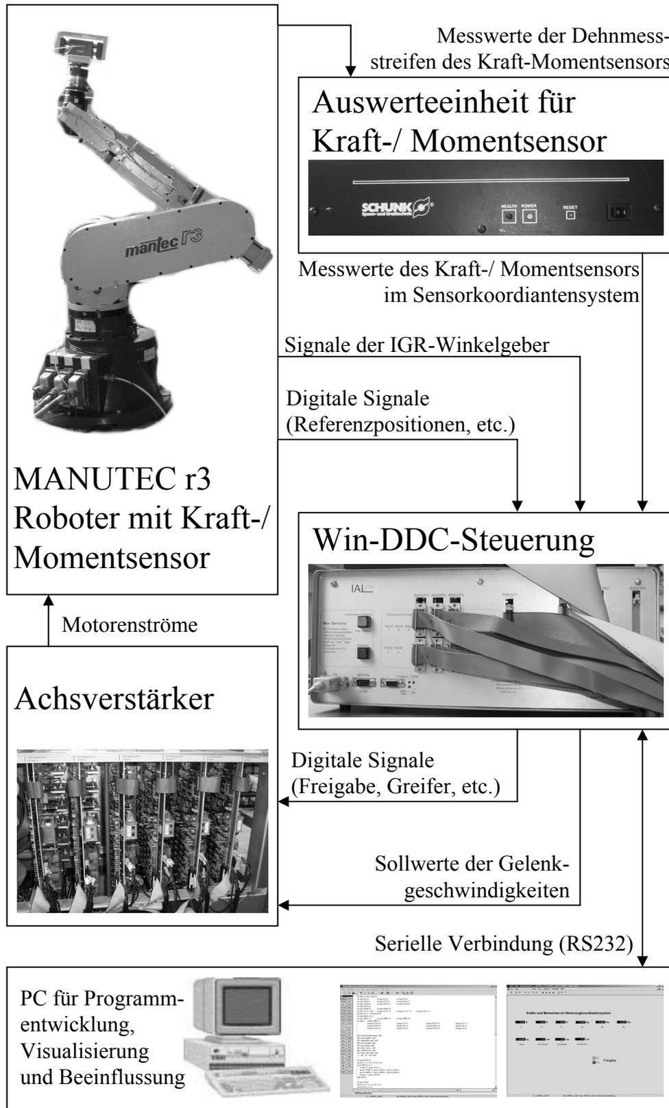
Abbildung 3.28: Struktur des MANUTEC r3 Robotersystems.
