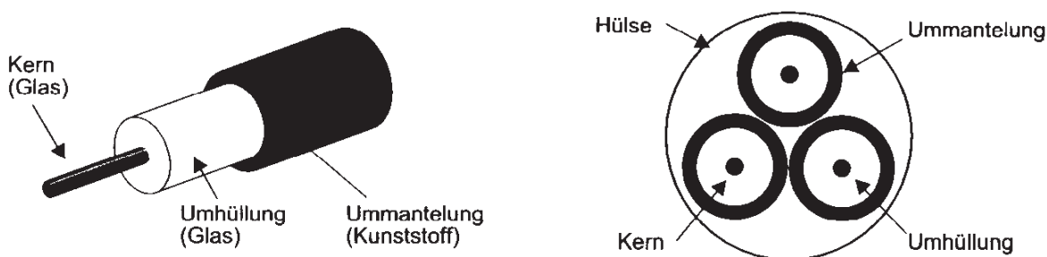
Abbildung 2.2: Aufbau eines Glasfaserkabels
