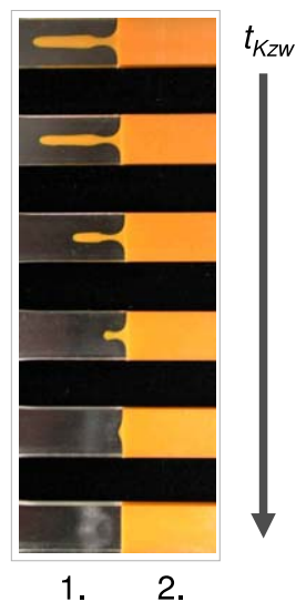
Bild 4.8: Grenzflächenprofile bei T_{M1,2} = 250^{\circ}\text{C} ; T_W = 40^{\circ}\text{C} mit zunehmender Zwischenkühlzeit (von 0 bis 7 s) (SAN/SAN)
