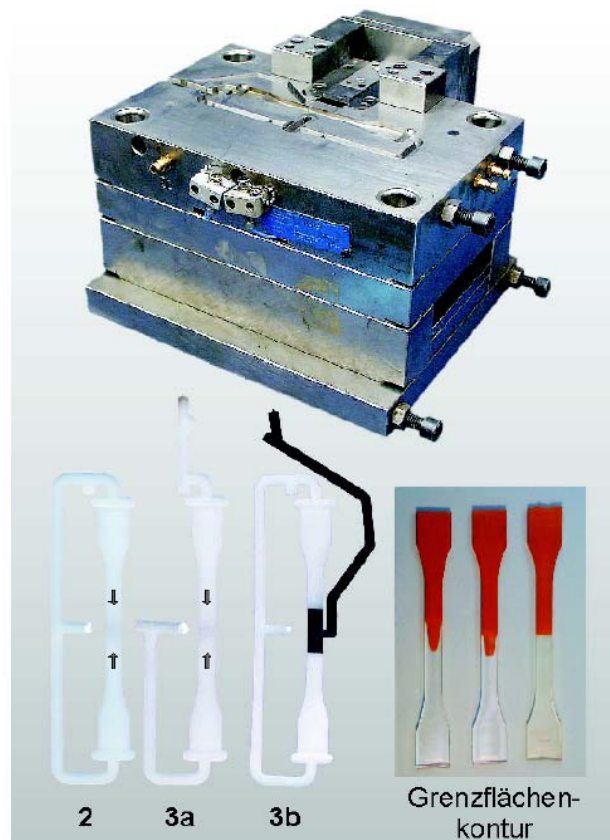
Bild 3.1: Zwei-K-Probekörperwerkzeug (Schließseite) mit Formfüllvarianten
