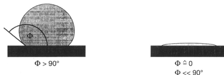
Bild 2.12: Beispiel für schlechte (links) und gute (rechts) Benetzung (nach [58])
