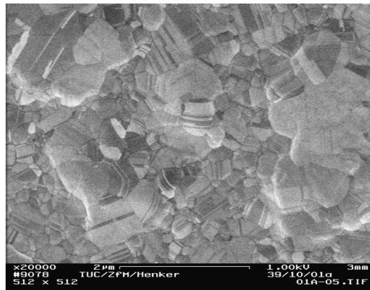
Bild 2.18: Abscheidung aus METFA auf eine 90 nm dicke, gesputterte Kupferschicht. Wafertemperatur: 300 °C, Prozesszeit: 60 min, Trägergas: 3,5 slm Ar; zusätzlich 350 sccm H 2 .
