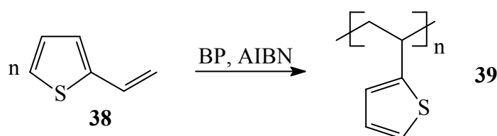
Abbildung 17: Radikalische Polymerisation von 2-Vinylthiophen
