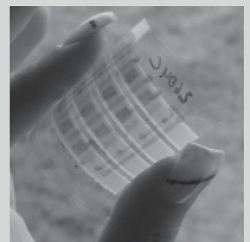
Gedruckter Schaltkreis mit 16 Transistoren vom pmTUC Foto: pmTUC
