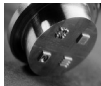
Prägestempel mit Mikrostrukturen
