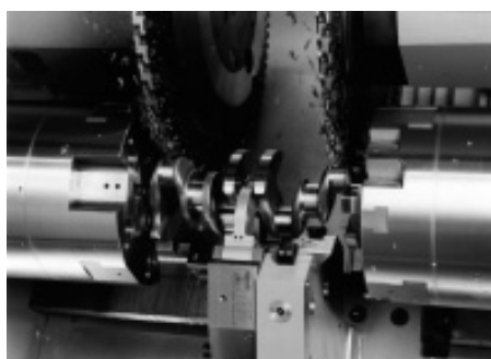
Kurbelwellen Fräs-Bearbeitungszentrum N 30 CM
