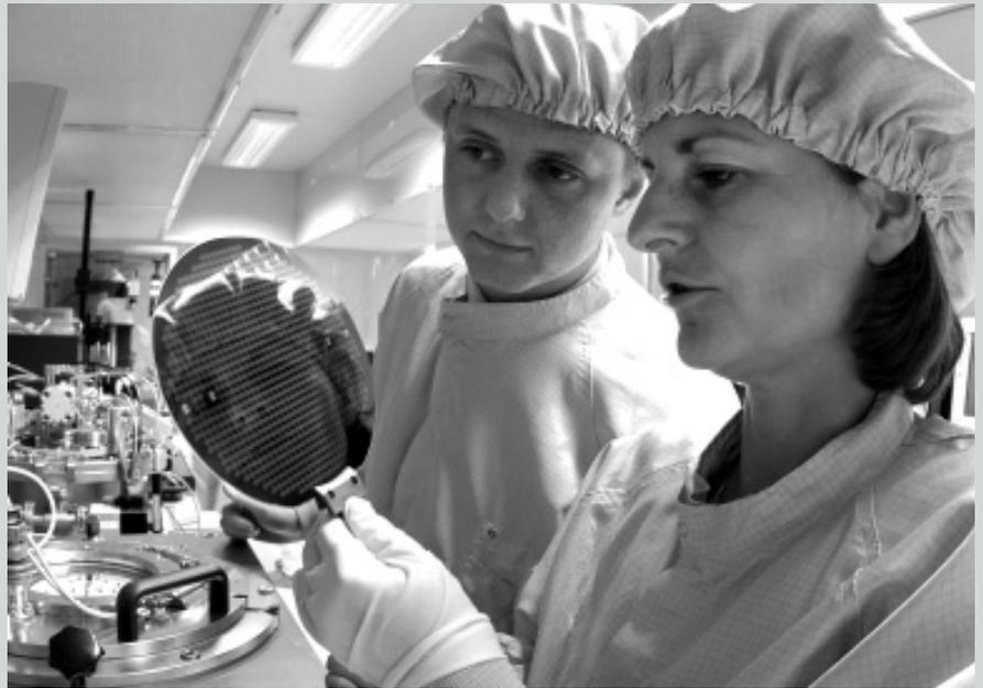
Ina Schubert und Mario Baum bei der Sichtkontrolle eines unter 400 Grad Celsius gefügten Waferverbundes.
