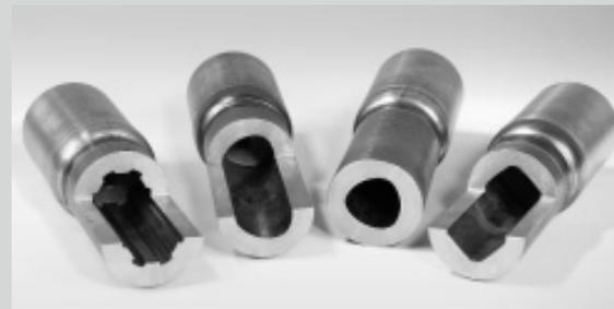
Innenprofile durch Bohrungsdrücken
