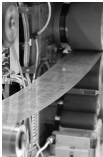
Auf einer Labordruckmaschine des Chemnitzer Institutes für Print- und Medientechnik werden die Strukturen von Transistoren im Massendruckverfahren auf Kunststofffolien gedruckt. Foto: Evelyn Oertel
