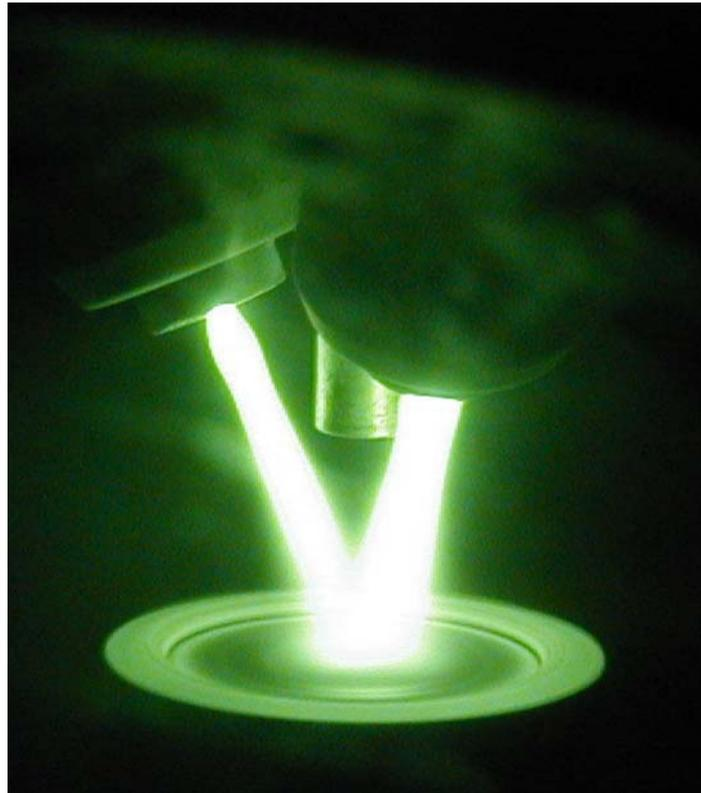
**Abbildung 59:** Drei-Brenner DC Plasmajet CVD Prozessbild während der Schichtsynthese mit dem Precursor HMDSO in einem Ar / H<sub>2</sub> Plasma bei 50 mm Substrat-abstand
