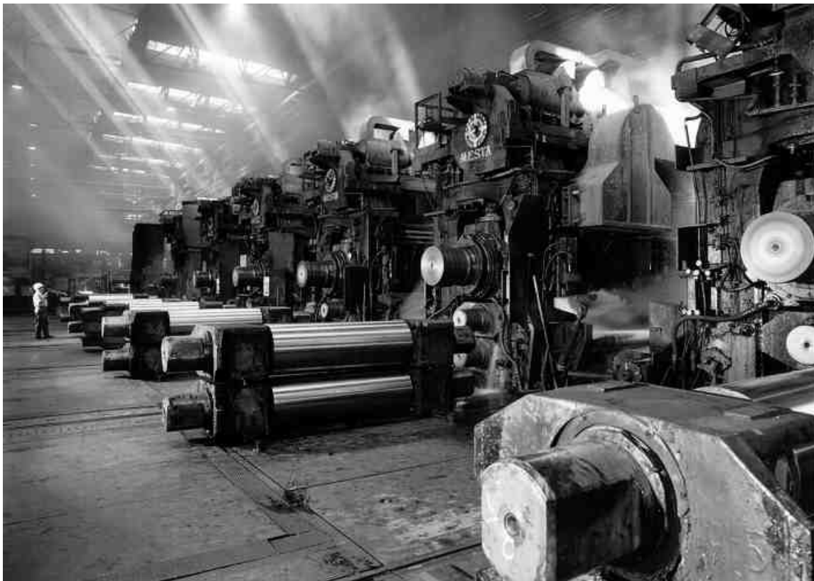
ABBILDUNG 38: Walzstraße zum Walzen von Stahlblech. Die Maschine besteht aus 7 identischen Walzgerüsten - der Prozess besteht aus 7 hintereinandergeschalteten Teilschritten. Messdaten liegen nur am Ein- und Ausgang vor.
