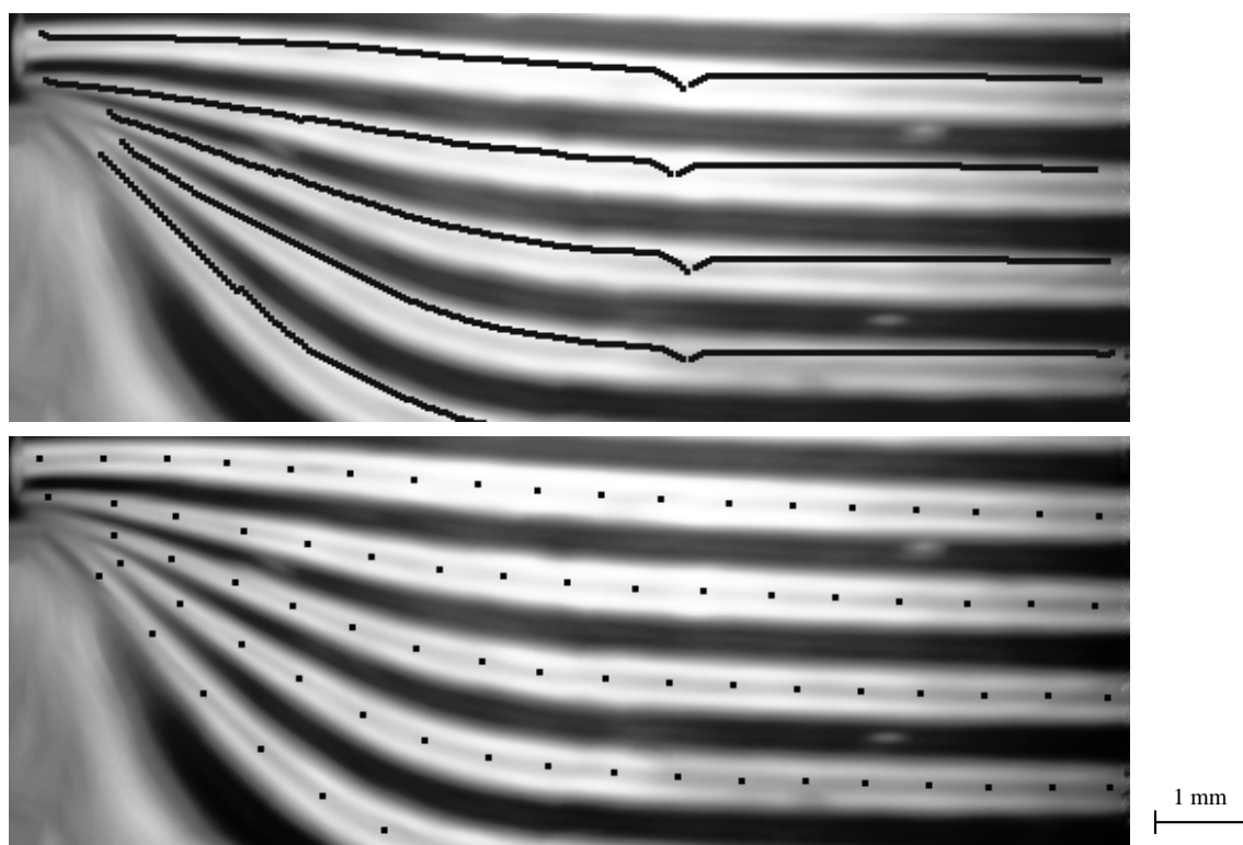
Bild 6.5: Ausschnitt aus einem gefilterten Isothetenfeld mit markiertem Verlauf der Linienverfolgung (oben) und mit identifizierten Stützpunkten in der Streifenmitte (unten)
