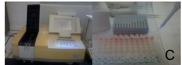
**Figura 8.** Preparación del batido de fresa utilizado para el análisis de la calidad del fruto (A), reflectómetro para la cuantificación de la Vitamina C (B) y espectrofotómetro y cubetas de reacción para la determinación capacidad antioxidante total (TEAC) (C).
