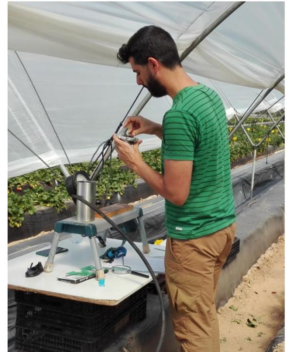
**Figura 7.** Equipo de presión para la medida del potencial hídrico *in situ*.
