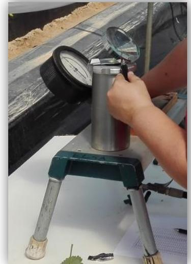
**Figura 14.** Detalle de la medición del potencial hídrico.
