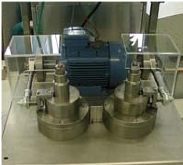
**Bild 6.11:** False Brinelling Prüfstand in seiner Ursprungskonfiguration
