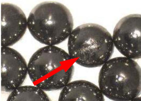
**Bild 6.19:** Prüfling 2 nach 70 Mio. Lastwechsell: Erste Oberflächenveränderungen an einzelnen Kugeln
