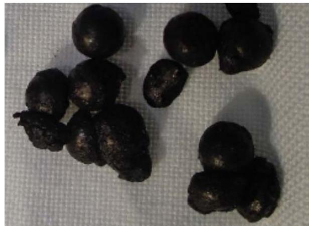
**Bild 6.24:** Wälzkörper von Prüfling V1.1
