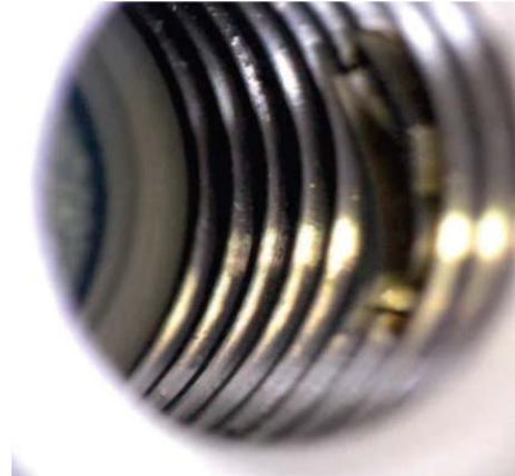
**Bild 6.28:** Spindel von Prüfling V3.1 nach Versuchsende
