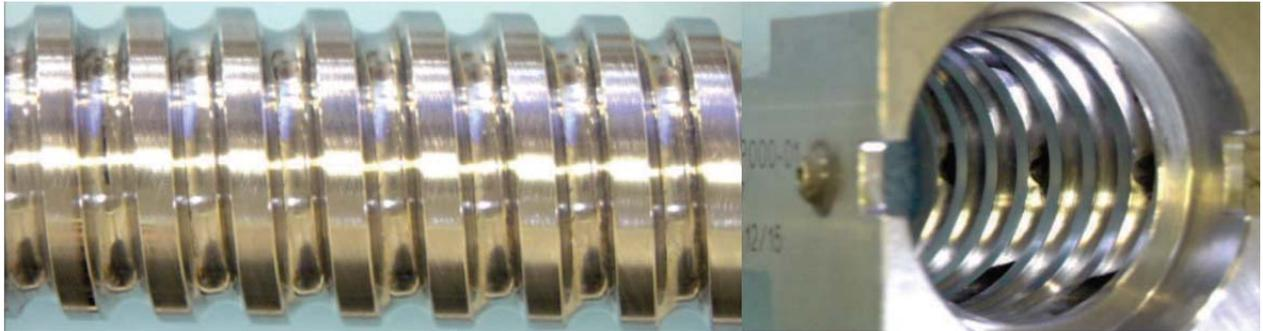
**Bild 6.25:** Spindel von Prüfling V2.1 nach Versuchsende
