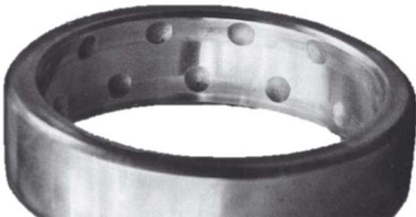
**Bild 3.11:** Stillstandsmarkierungen (Überlast) am Außenring eines zweireihigen Pendelkugellagers, nach [SKF08, Seite 11]
