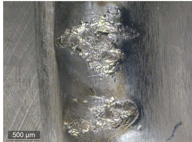
**Bild 6.18:** Prüfling 2 nach 70 Mio. Lastwechsell: Ermüdungserscheinungen an der Laufbahn
