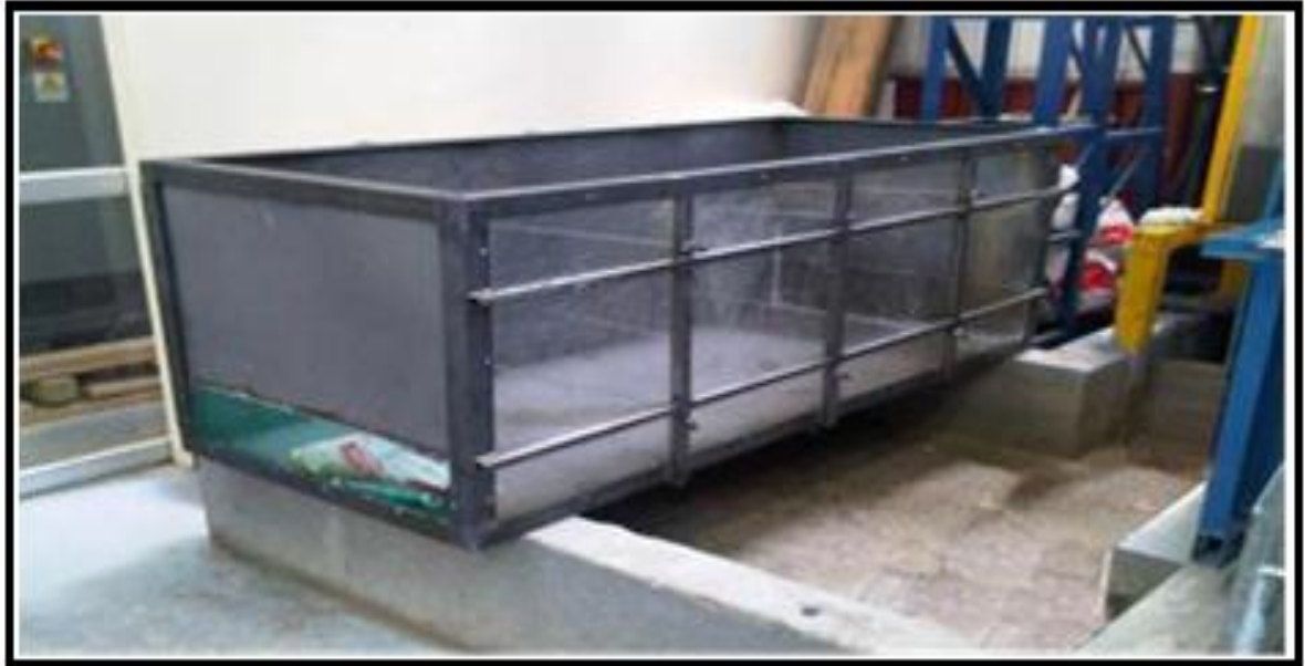
Figura 1. Modelo de trinchera de retención.
