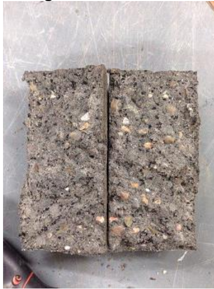
Figura 32. Falla a tracción indirecta espécimen de concreto modificado con grano de caucho.
