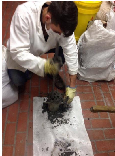
Figura 15. Realizando los Especímenes de Concreto Universidad Católica de Colombia.
