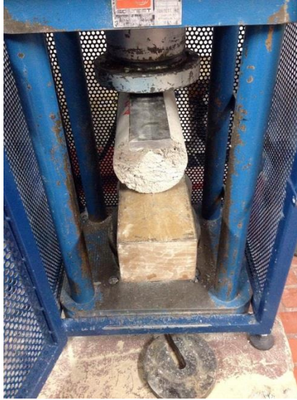
Figura 21. Espécimen de Hormigón Sometido a Ensayo de Tracción Indirecta.
