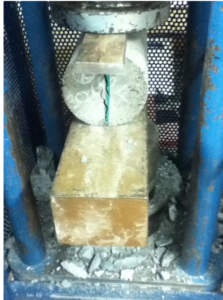
Figura 22. Falla Cilindro de hormigón sometido a tracción indirecta NTC 722.
