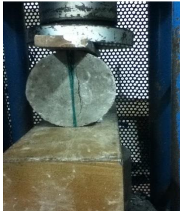
Figura 4. Espécimen colocado en una máquina de ensayo para determinar la resistencia a la tensión indirecta NTC 722.
