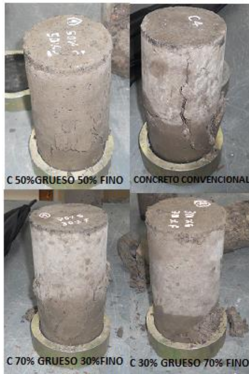
Figura 28. Fracturas presentadas en especímenes de concreto convencional y modificados con grano de caucho reciclado.
