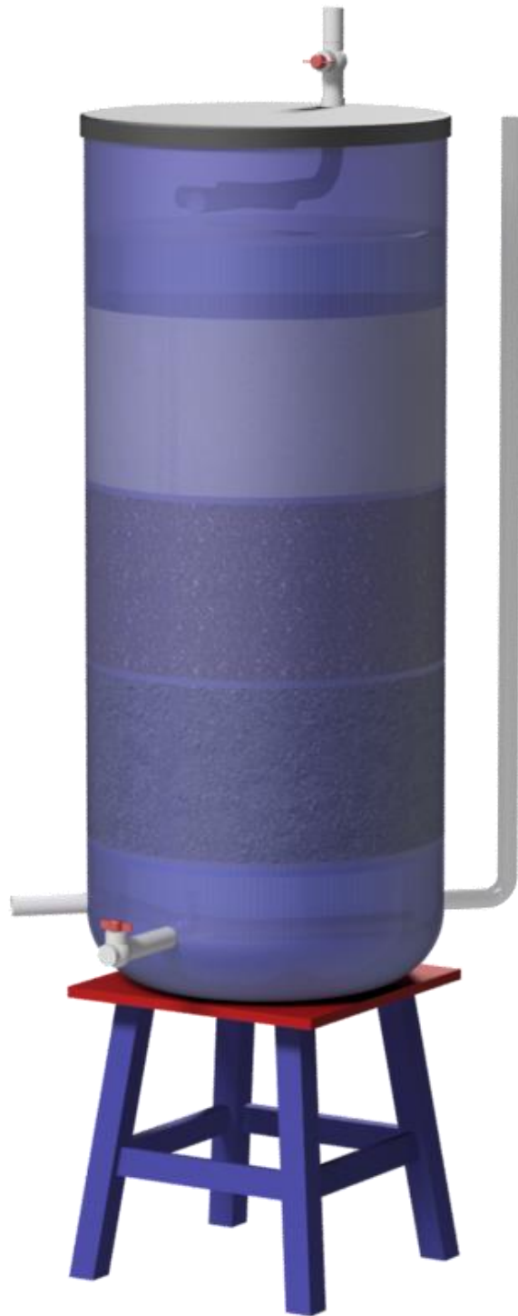
Ilustración 66. Filtro visualización de lechos filtrantes
