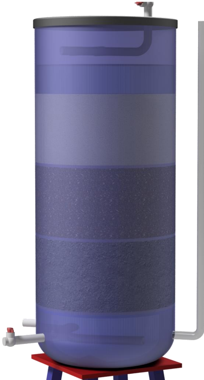
Ilustración 67. Ampliación Lechos filtrantes
