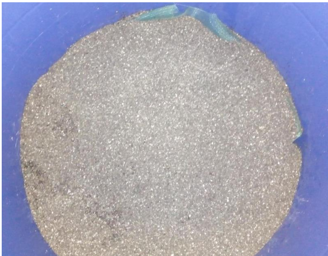
Ilustración 38. Lecho filtrante de antracita
