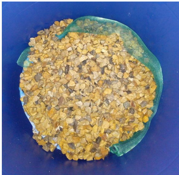
Ilustración 37. Lecho filtrante de grava
