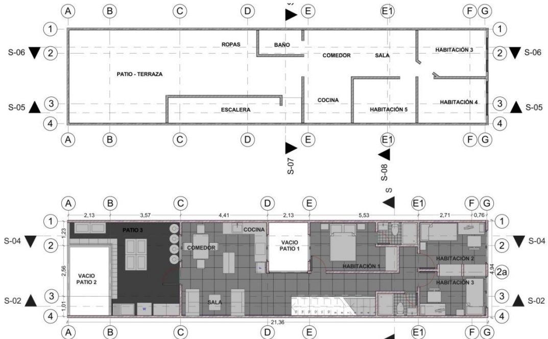
Ilustración 75 Planta de segundo nivel existente y propuesta, evidenciando los cambios y traslado de espacios. Elaboración propia 2017.
