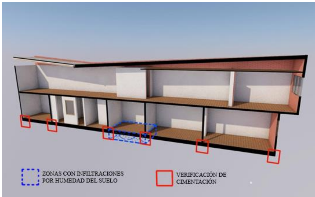
Ilustración 53 Imagen indicando las zonas a verificar en cuanto a humedades y cimentaciones. Elaboración propia 2017.
