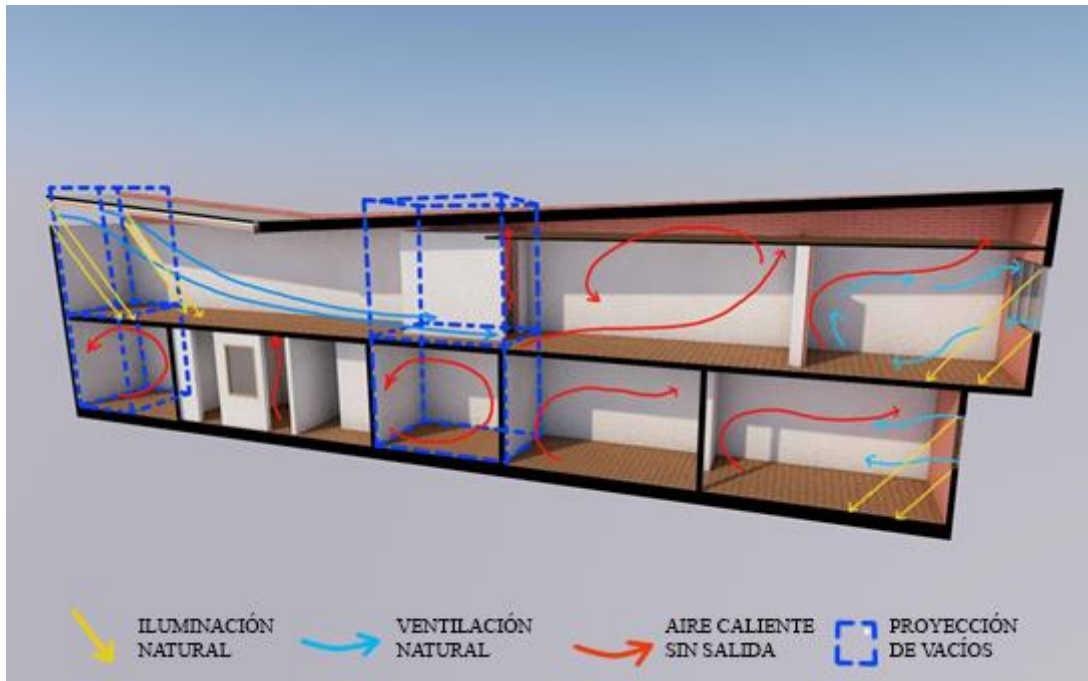
Ilustración 55 Imagen indicando las zonas de aislamiento y vacío, ausentes en el modelo existente evidenciando la mala ventilación e iluminación en el interior de los espacios. Elaboración propia 2017.
