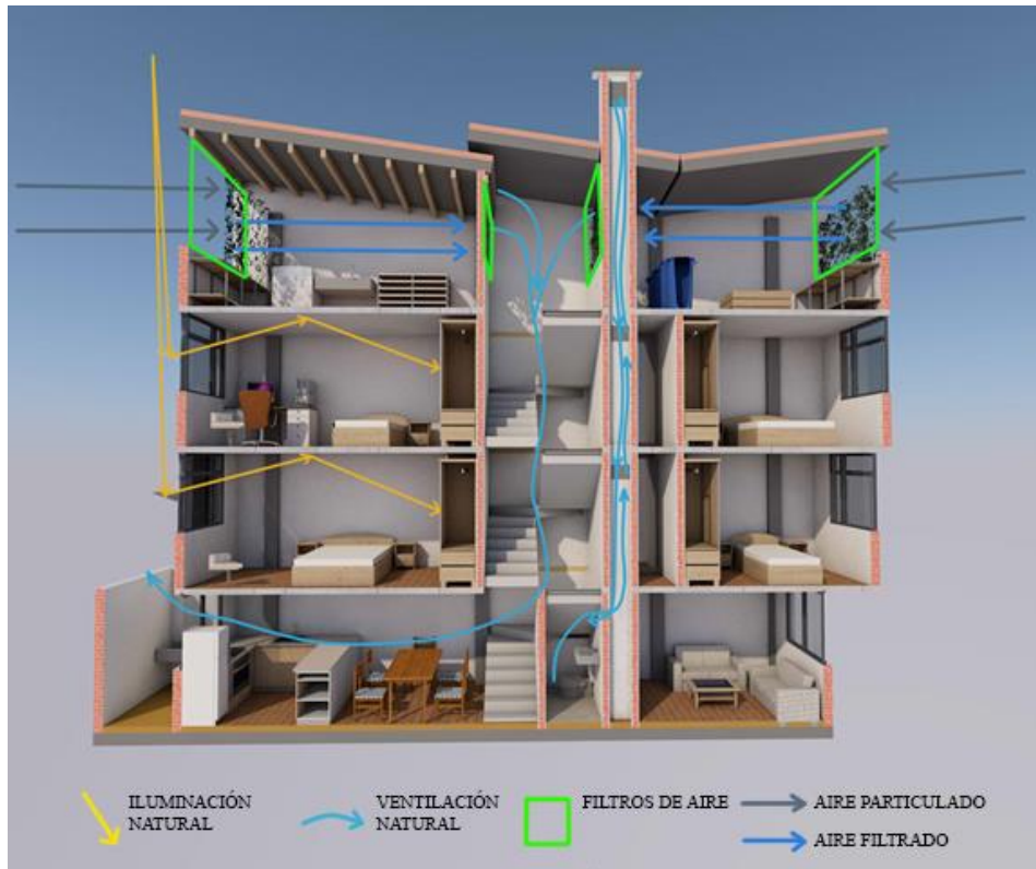
Ilustración 65 Corte indicando las zonas intervenidas y su efecto en cuanto a ventilación e iluminación natural. Elaboración propia 2017.
