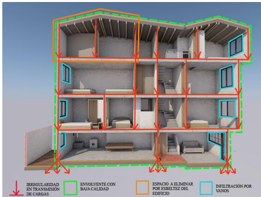
Ilustración 60 Imagen indicando problemas de materialidad. Elaboración propia 2017.
