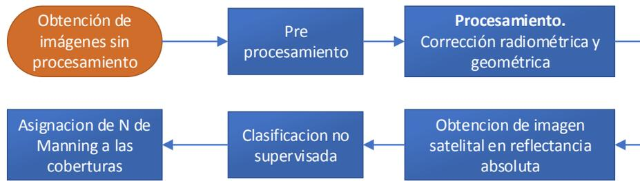
**Figura 3.1-7 Proceso para obtención de imagen satelital en reflectancia absoluta**
