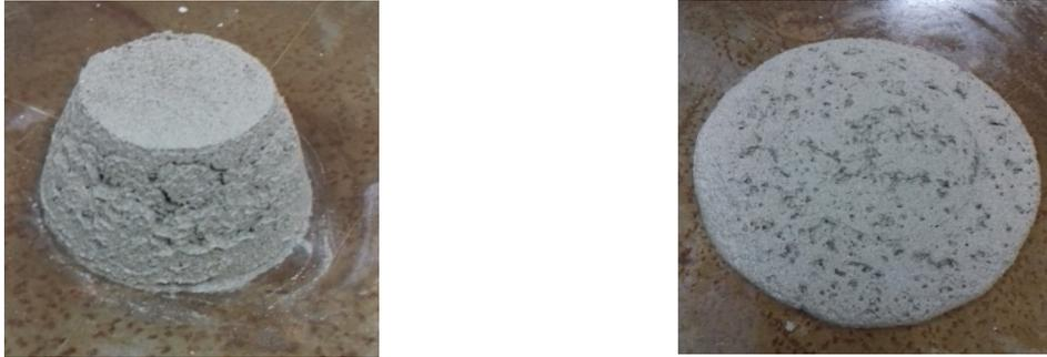
Figura 1 – Ensaio mesa de consistência realizado no Laboratório de Concreto de Itaipu.
