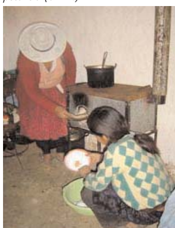
Figura 5.67. Cocina eficiente a leña de 4 kW de potencia (CEL-4)
