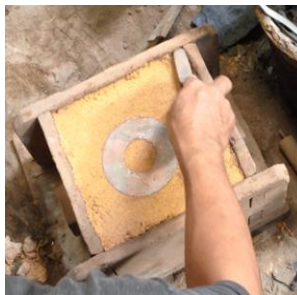
Gambar 5. Mengambil papan kayu yang berada diatas dan meratakan pasir
