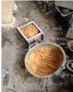
Gambar 4. Mengisi kerangka cetakan dengan pasir silika yang sudah di campur dengan water glass .
