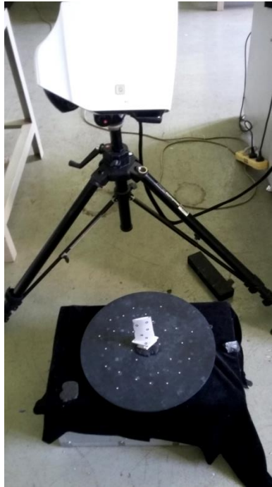
Gambar 8. Proses pengambilan gambar benda kerja
