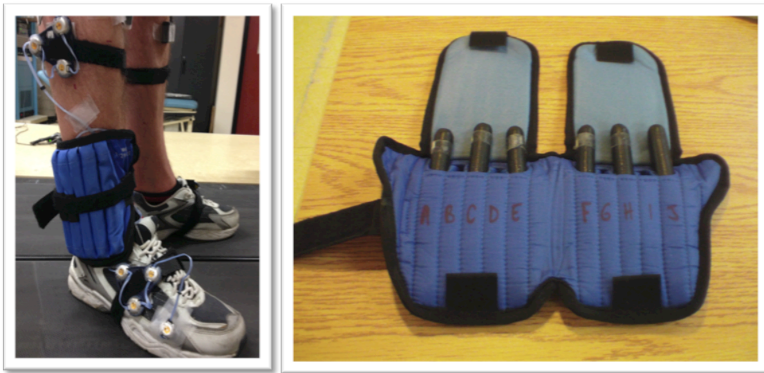
Figure 4.2. Charge à la cheville avec six cylindres de métal équivalents à 1,5 kg.
