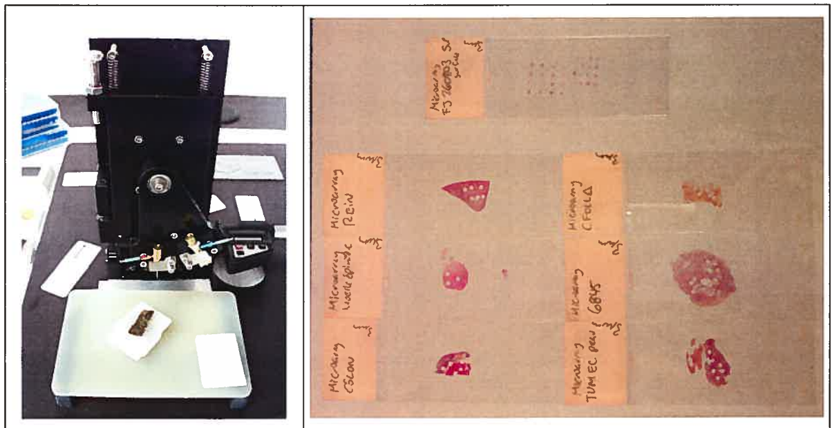
Figure 37 Appareil semi-automatique permettant la création de microarrays tissulaires
