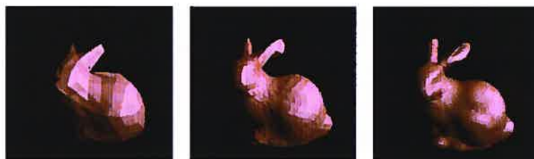
Figure 4.2. Reconstruction à trois différents stages de l'algorithme (320, 1280 et 5120 triangles). Image tirée de [94].
