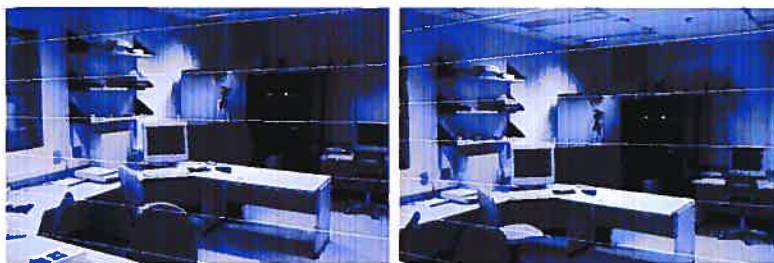
Figure 3.5. Chaque droite dans l'image de gauche est associée à son équivalente dans l'image de droite. La géométrie épipolaire nous garantit que tous les points sur une des lignes blanches de l'image de gauche se retrouveront nécessairement sur la droite équivalente de l'image de droite, à l'exception des cas inévitables d'occlusions.
