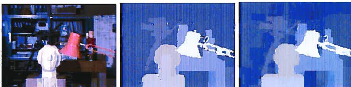
Figure 3.7. (Gauche) Image de référence de l'université de Tsukuba. (Milieu) Résultats obtenus par la méthode de Graph-Cuts (24 secondes). (Droite) Résultats obtenus par la méthode de Max-Flow.
