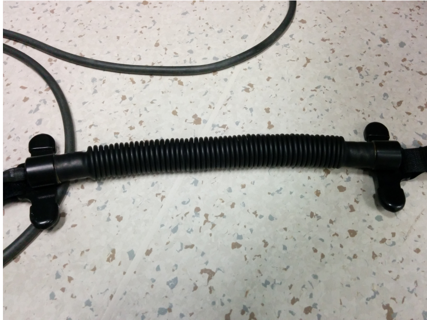
Figure 3.6 – Le Bellows Belt, une ceinture abdominale pneumatique produisant un signal numérique proportionnel à la pression interne (ou au volume interne), a été employé comme appareil de suivi respiratoire pour ce projet.
