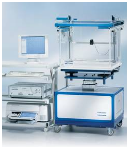
Figure 3.1 – Photographie d'une cuve à eau Blue Phantom d'IBA. Sur cette photo sont illustrés la cuve à eau sur la base dont la hauteur est ajustable (à droite) ainsi que le poste de contrôle (à gauche) [75].
