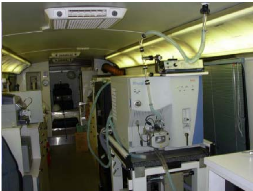
Figure 4.4 —Système analytique APCI-MS/MS installé dans le TAGA du Ministère de l'environnement du Québec
