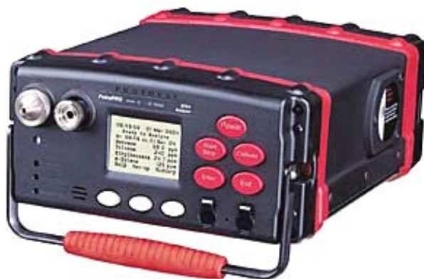
Figure 2.12 —Analyseur de BTEX GC portable PetroPRO de Photovac
