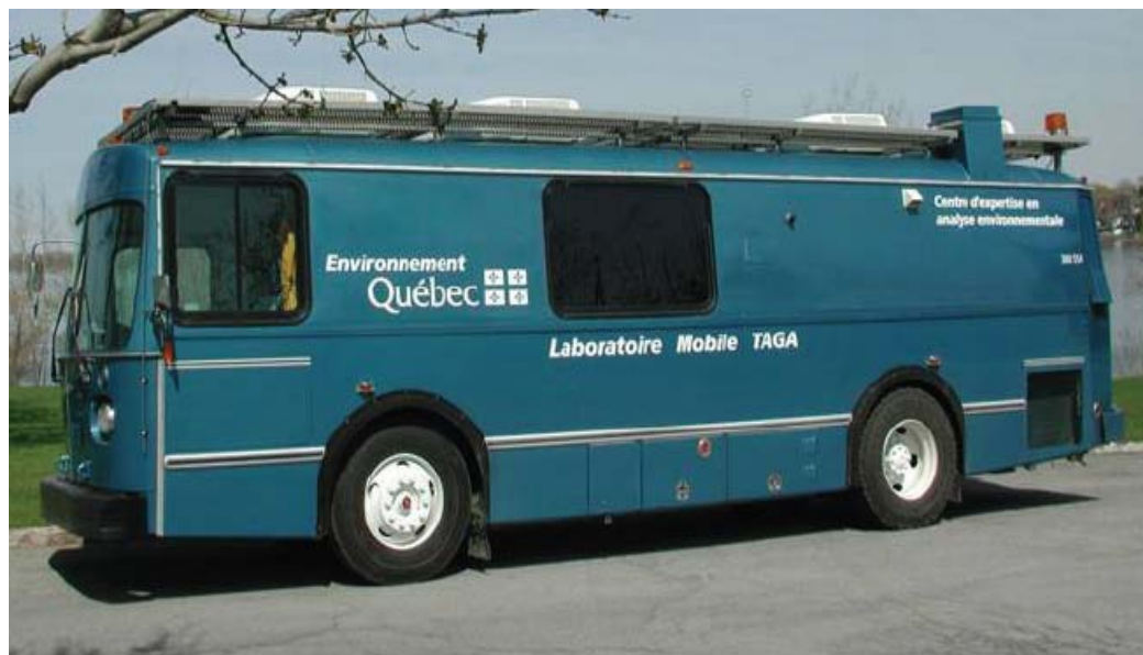
Figure 4.3 —Vue extérieure du laboratoire mobile TAGA du Ministère de l'environnement du Québec. Il s'agit d'un TAGA modèle 6000
