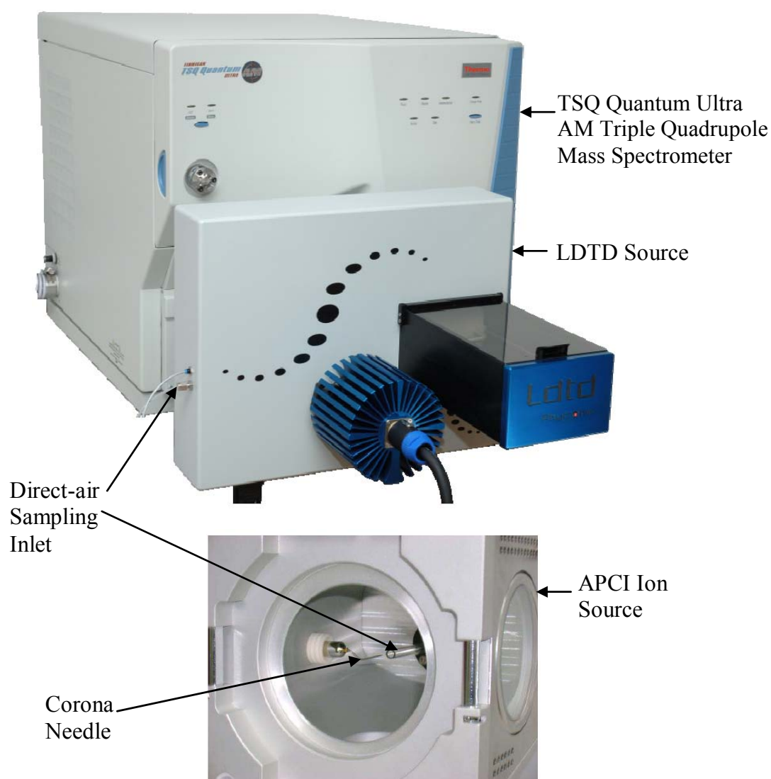
Figure 5.15 –Photographies de la source LDTD-APCI couplée avec un spectromètre de masse à triple quadripôle
