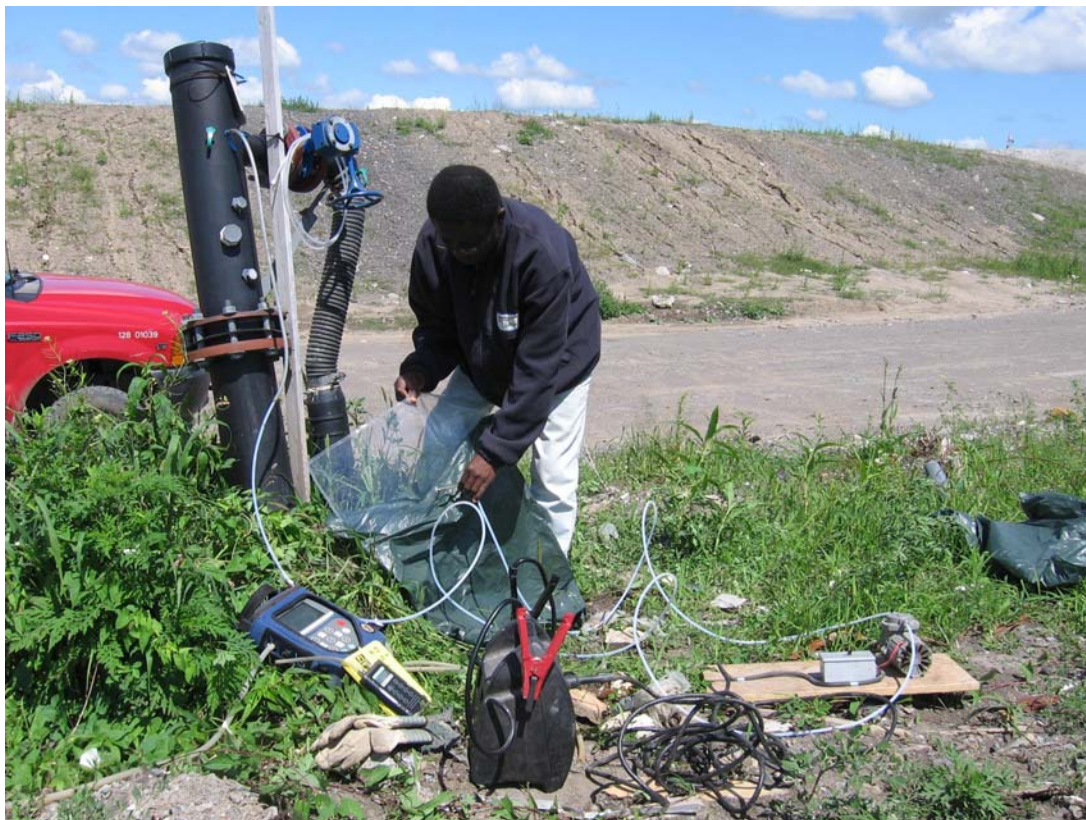
Figure 9.6 —Échantillonnage de biogaz au site d'enfouissement sanitaire du CESM. Les échantillons sont prélevés dans un sac de Téflon au moyen d'une pompe et d'un tuyau en Téflon. Le sac d'échantillonnage est protégé avec un sac sombre pour prévenir la dégradation photochimique des D4 et D5
