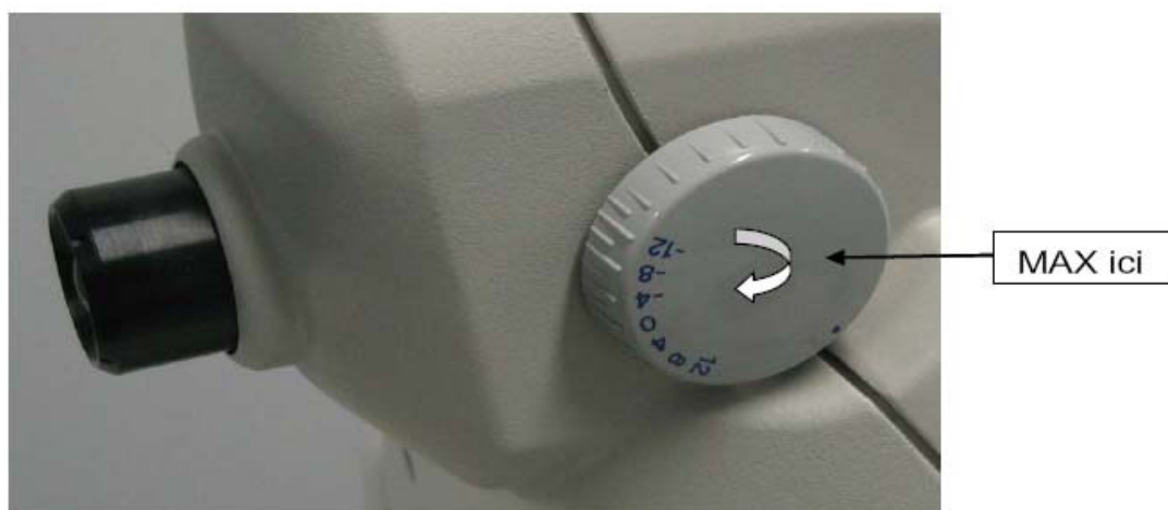
Figure A.1.1 : Calibration des images OCT.Étape préliminaire 1 : La mise au point de l'appareil a été effectuée sur la cornée en tournant la roulette de la lentille jusqu'au zoom maximal.
