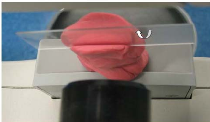
Figure A.4.4 : Calibration des images OCT.Étape préliminaire 2 (Mesure 1) : Alignement du point le plus haut de l'objet au centre de l'image.
