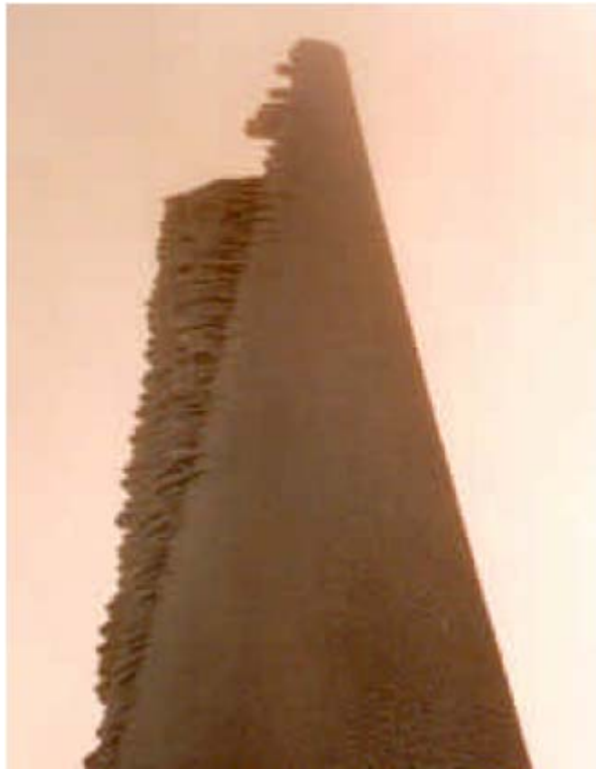
Rotorblatt mit Eisansatz an der Profilvorderkante [DEWI Magazin Nr. 10, Feb. 1997]
