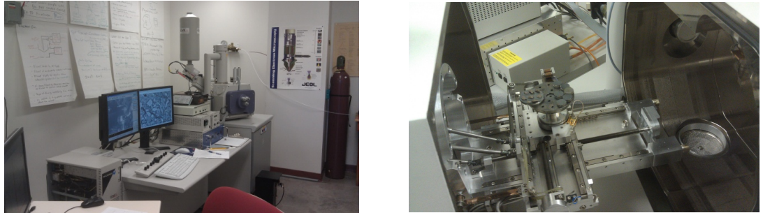
Figure 3.25. ESEM and inside the ESEM.
