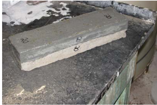
(d) Composite specimen after demolding.
