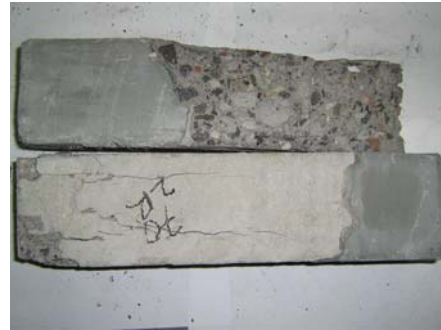
(d) C: concrete failure.
