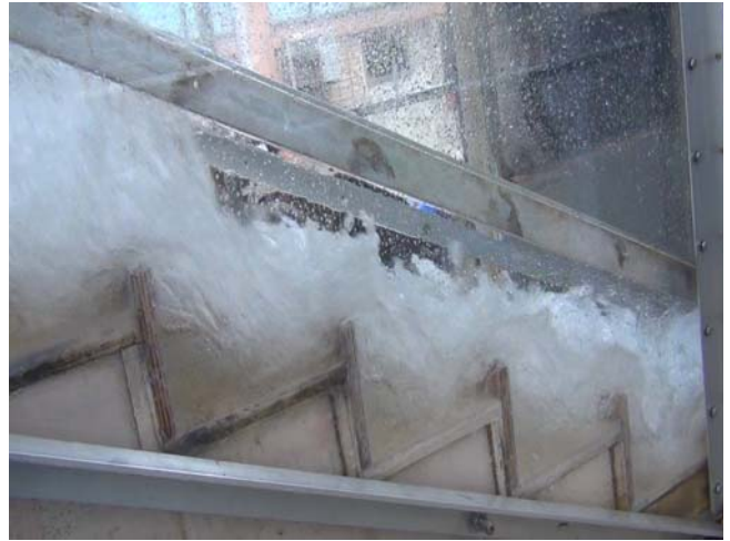
(D) d_c/h = 0.65 , Q = 0.027 m 3 /s, Re = 2.1 \times 10^4
