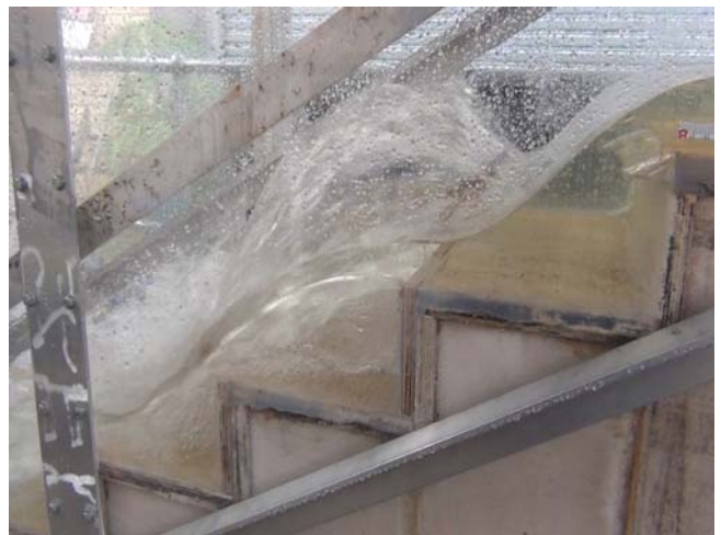
(D) dc/h = 0.55 , Q = 0.021 m 3 /s, Re = 1.6 \times 10^5
