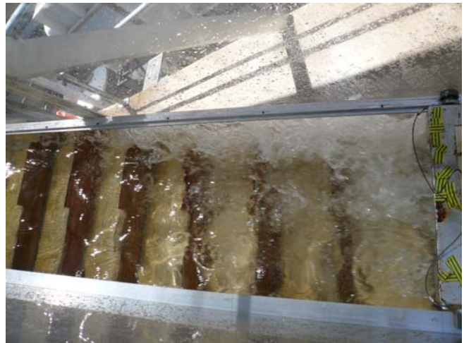
(D) d_c/h = 1.45 , Q = 0.092 m 3 /s, Re = 6.9 \times 10^5
