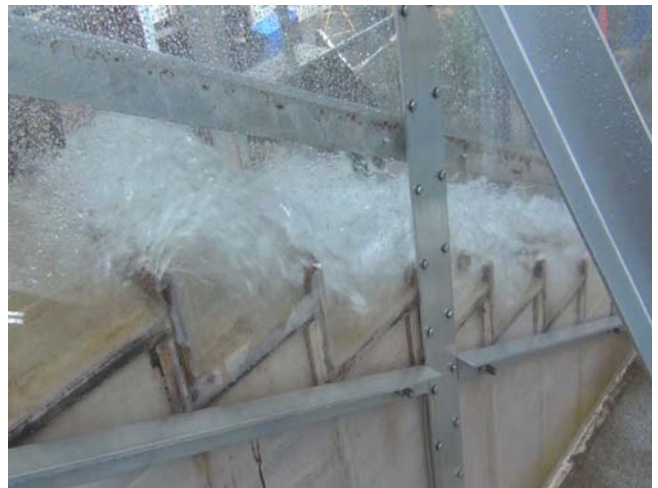
(D) d_c/h = 0.46 , Q = 0.016\text{m}^3/\text{s} , Re = 1.2310^5
