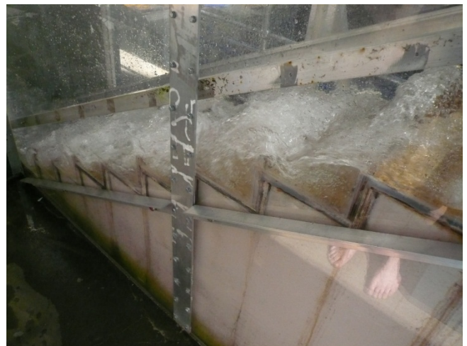
(D) d_c/h = 0.29 , Q = 0.009 m 3 /s, Re = 6.2 \times 10^4
